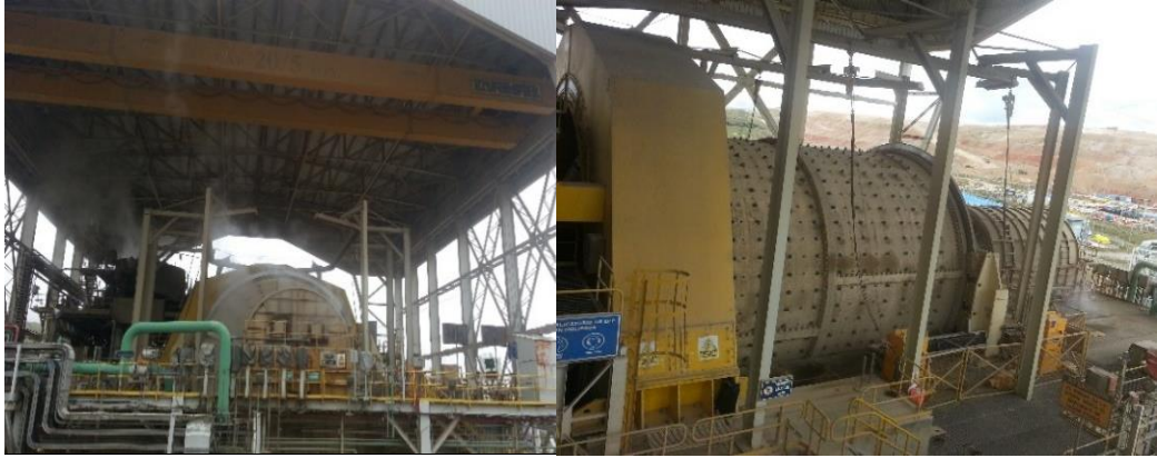
Figura 1. Molino SAG de la Planta Gold Mill - Minera Yanacocha S.R.L. Fuente: Elaboración propia 2015.
