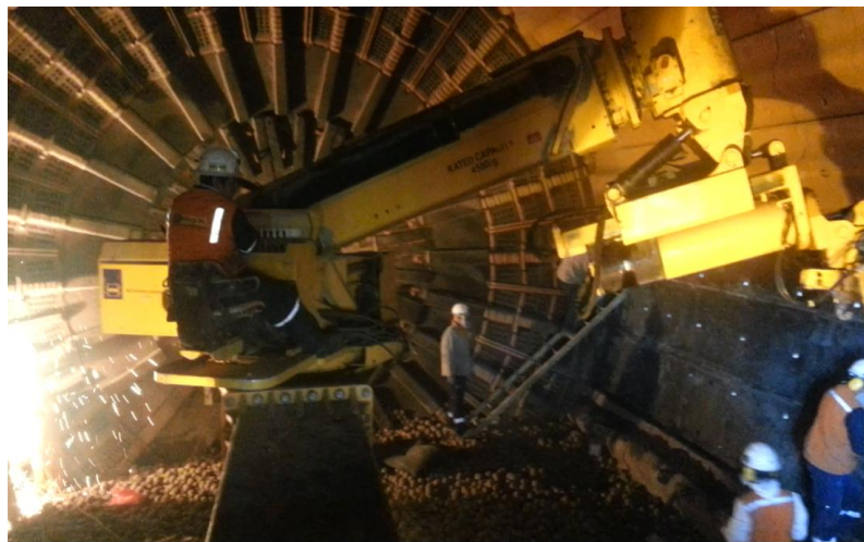
Figura 14. Máquina de revestidos de molinos SAG Russell Fuente: Elaboración propia 2015
