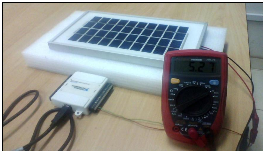
FIGURA: 2.8 -“Modulo Fotovoltaico de 5 Watt, para Medir Radiación”
