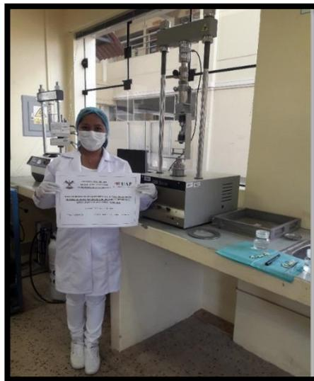
Máquina de Ensayos para Tracción CBR el cual se realizó la resistencia a la tracción de las muestras, en el laboratorio de suelos.
