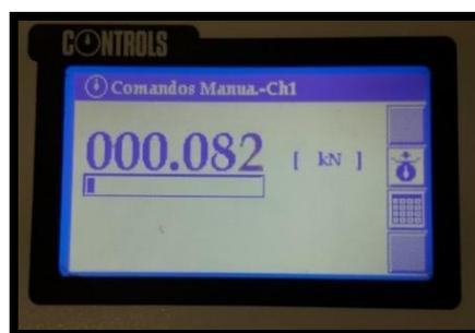
Observando la resistencia a la tracción vertical expresado por KN posteriormente convertido en Mpa.
