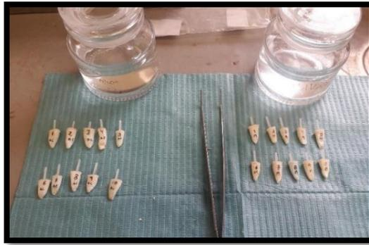
Las 20 muestras de los premolares inferiores finalizadas para ya poder realizar la prueba de tracción.
