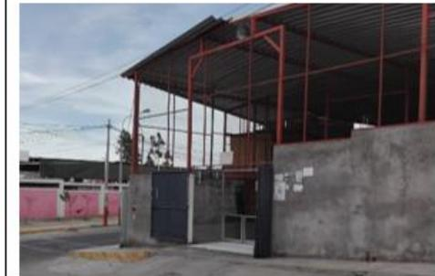
La infraestructura no es mala cuenta con una estructura metálica con calaminas como cobertura general para el mercado los puestos estas construidos de cemento y ladrillo y algunas divisiones con diferentes tipas de materiales (material noble, calaminas, maderas) no se encuentra con facilidad el ingreso no cuenta con estacionamiento de descarga ni para clientes.
