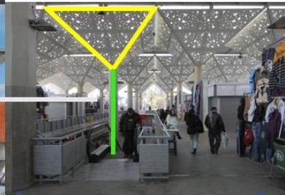
CADA MÓDULO ESTÁ CONFORMADO POR UNA ESTRUCTURA PIRAMIDAL INVERTIDA CON TECHO TRASLUCIDO QUE GENERA LA ILUMINACIÓN INTERIOR REINTERPRETANDO EL FOLLAJE DE LOS ÁRBOLES, PERMITIENDO MANTENER LA IDEA DE UN MERCADO AL AIRE LIBRE
