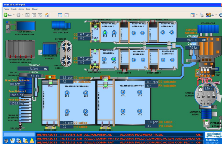
Control Scada de PTAR
