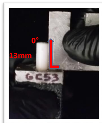
Figura 5. Parámetros para la preparación de las muestras para la realización de la prueba de tracción.
