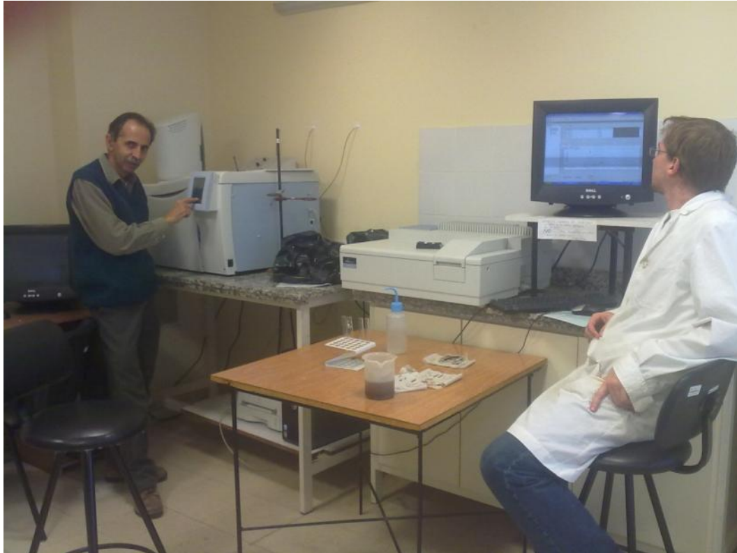
Fotografía 02: Análisis Espectrofotométrico del humo de sílice en el Observatorio de Aire Suelo y Agua. Córdoba-Argentina.
