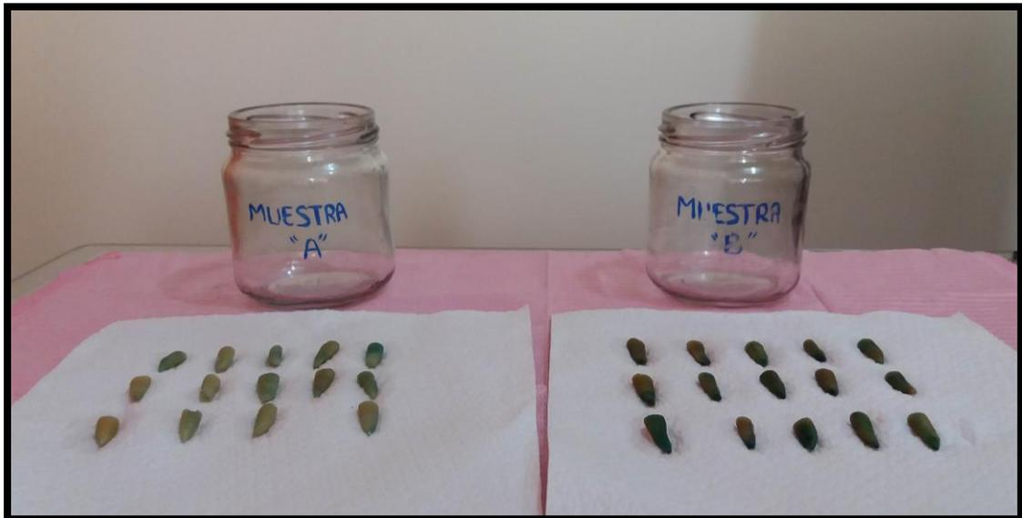
Foto 20: Secado de las muestras al medio ambiente por 3 horas
