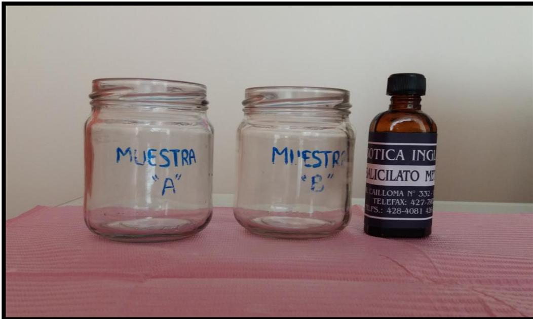
Foto 23: Muestras colocadas en salicilato de metilo por 2 horas
