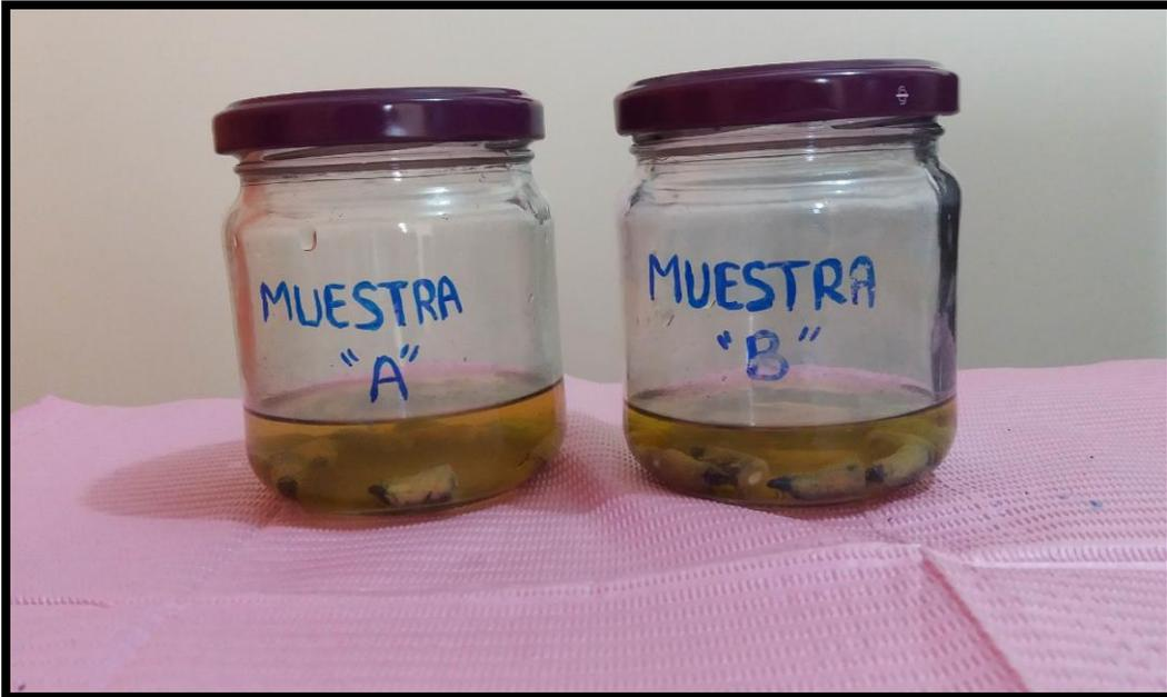
Foto 18: Muestras colocadas en ácido nítrico al 5% por tres días
