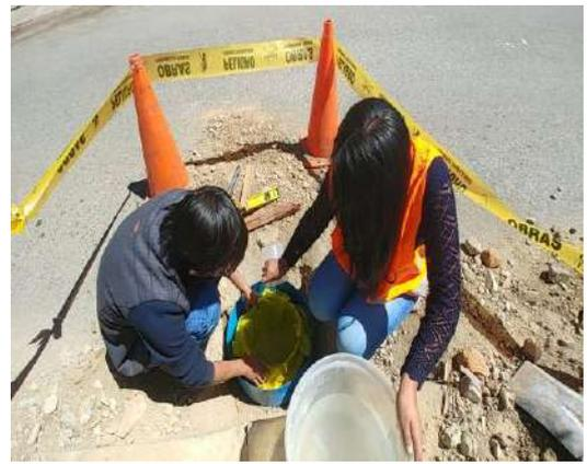
*Figura 3.11: Llenado de agua dentro del cilindro de 45cm y luego dentro del cilindro de 30cm de diámetro*
