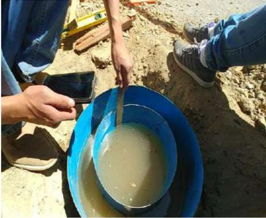
Figura 3.12: Controlar el tiempo de infiltración
