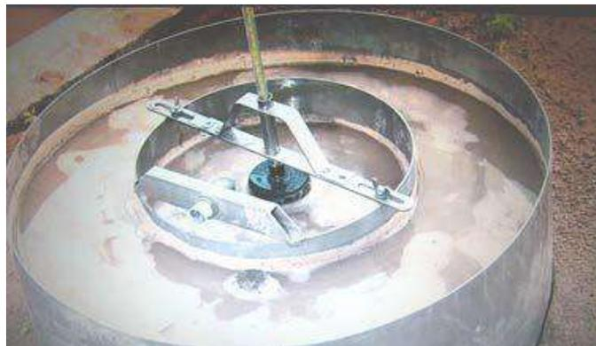
*Figura 3. 7: Infiltrómetro doble anillo*
