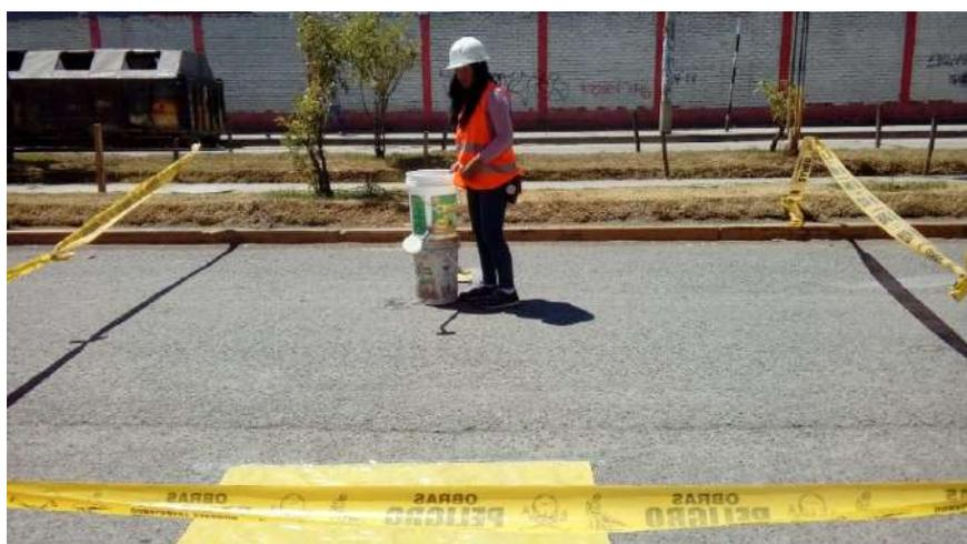
Figura 3. 28: Ensayo de infiltración en fallas longitudinales con escurrimiento longitudinal
