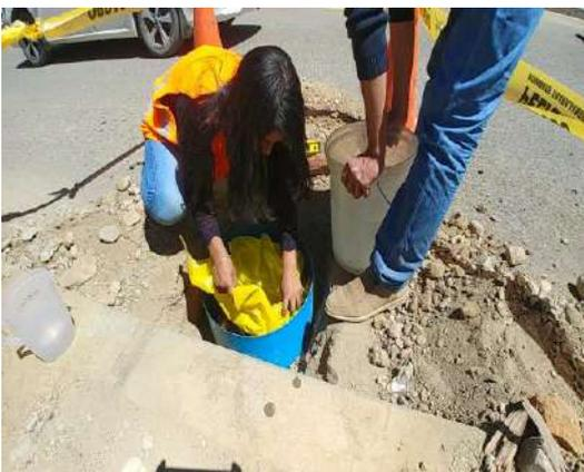
*Figura 3.9: Colocación de una lámina de plástico dentro del anillo de 30cm de Diámetro*
