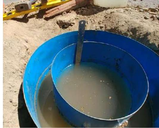
Figura 3.13: Toma de medidas con la regla metálica dentro del cilindro de 30cm de diámetro
