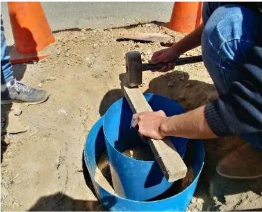
*Figura 3.8: Ubicación e introducción del cilindro de Doble Anillo.*
