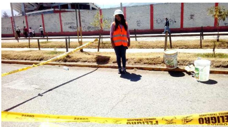
Figura 3. 29: Ensayo de infiltración en fallas transversales con escurrimiento longitudinal
