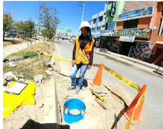
*Figura 3.10: Nivelación de cilindro de Doble Anillo*
