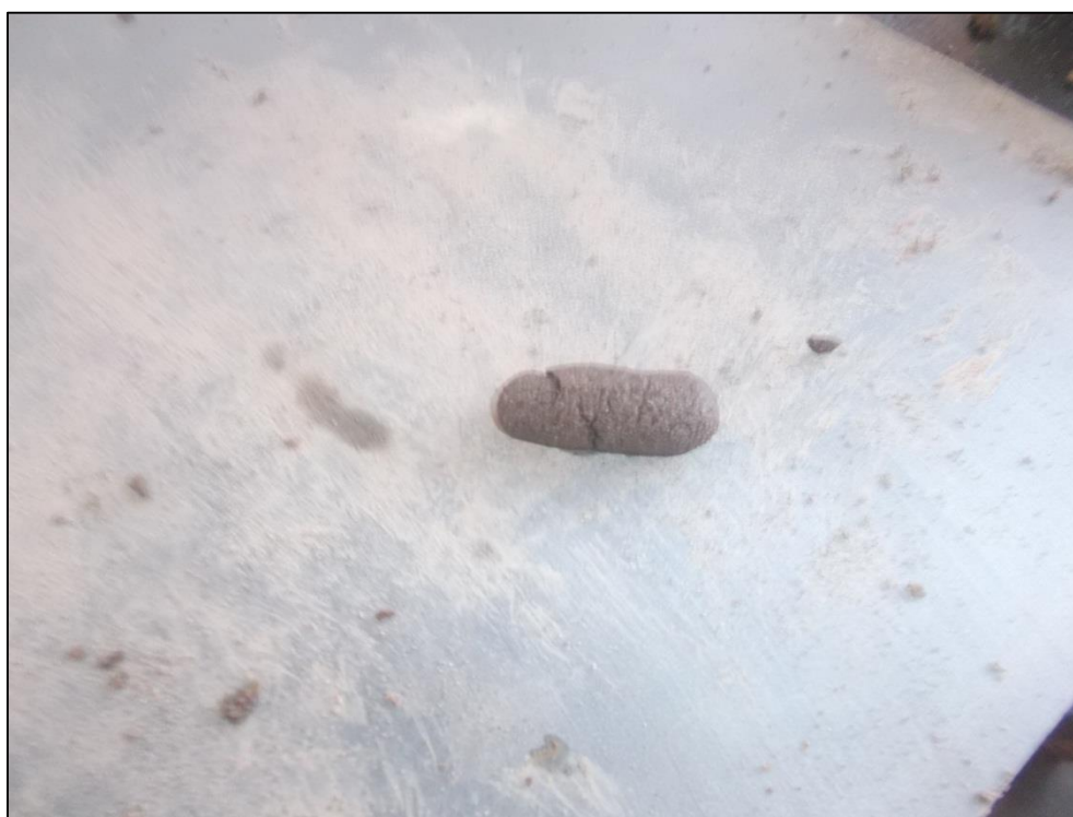
Figura 5-7: Muestra cuarteada y con tendencia a la fractura
