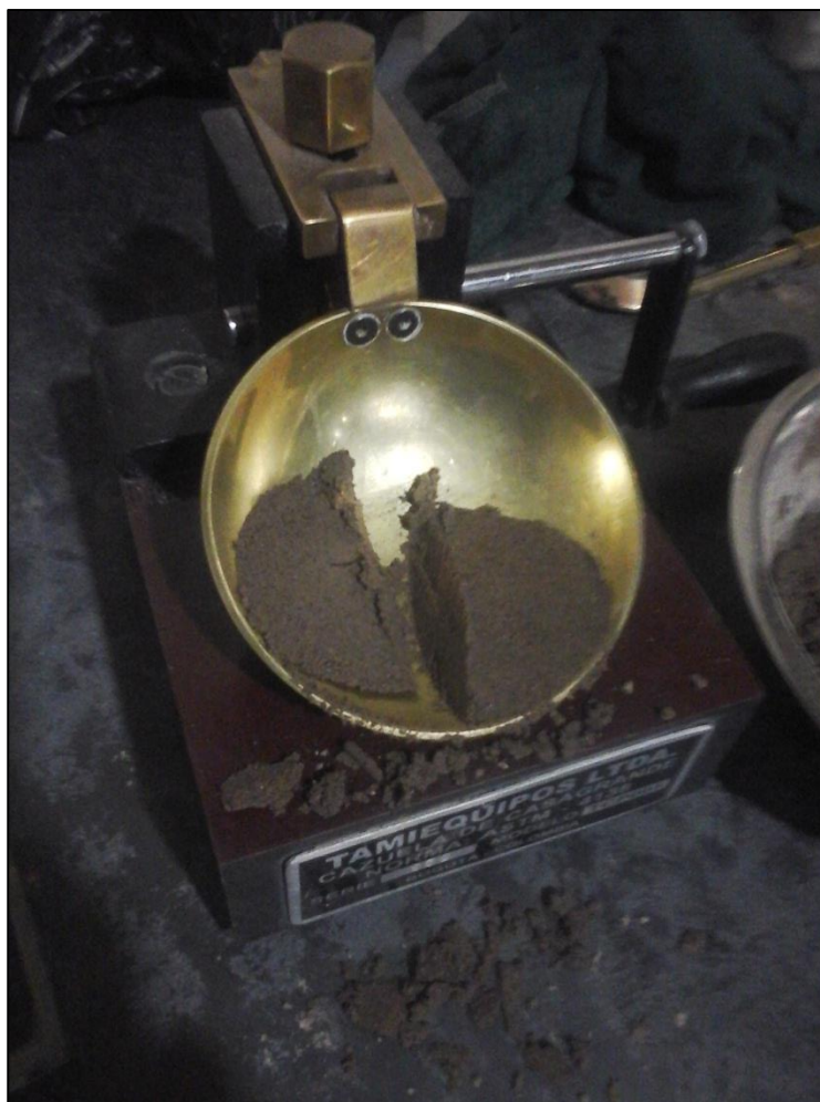
Figura 5-5: Ensayo de Límite Líquido en la cuchara de Casagrande, se muestra que el suelo se desprendió antes de los 10 golpes.
