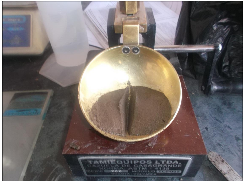
Figura 5-2: Ensayo de Límite Líquido en la cuchara de Casagrande, se muestra la unión antes de los 10 golpes.
