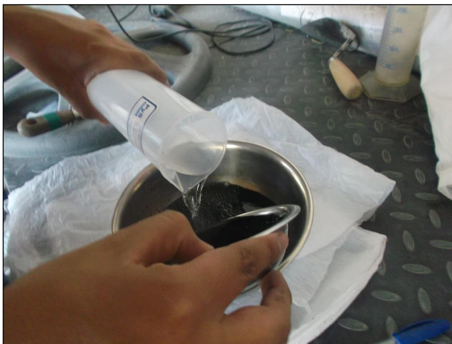
Figura 5-27: mezclado del polímero con el agua según dosificación
