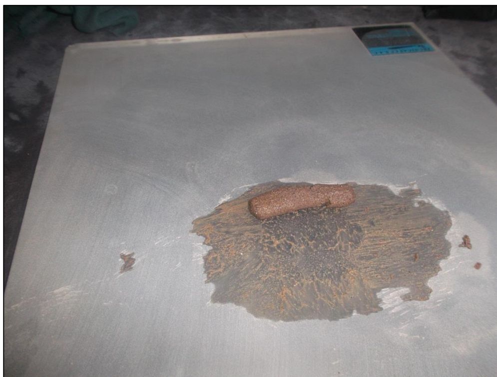
Figura 5-10: Muestra cuarteada y con tendencia a la fractura
