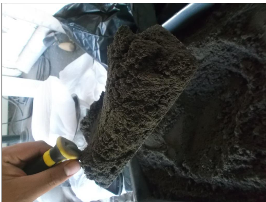
Figura 5-31: suelo con estabilizador
