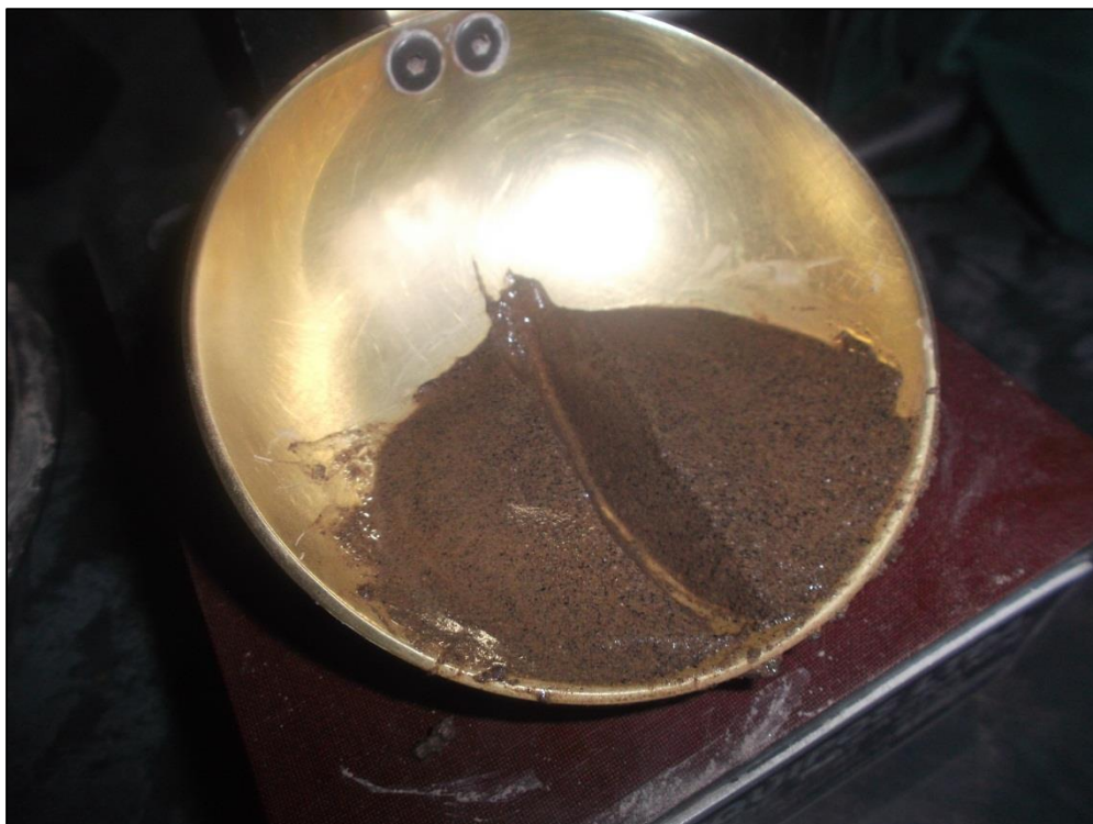
Figura 5-3: Ensayo de Límite Líquido en la cuchara de Casagrande, se muestra la unión antes de los 10 golpes.
