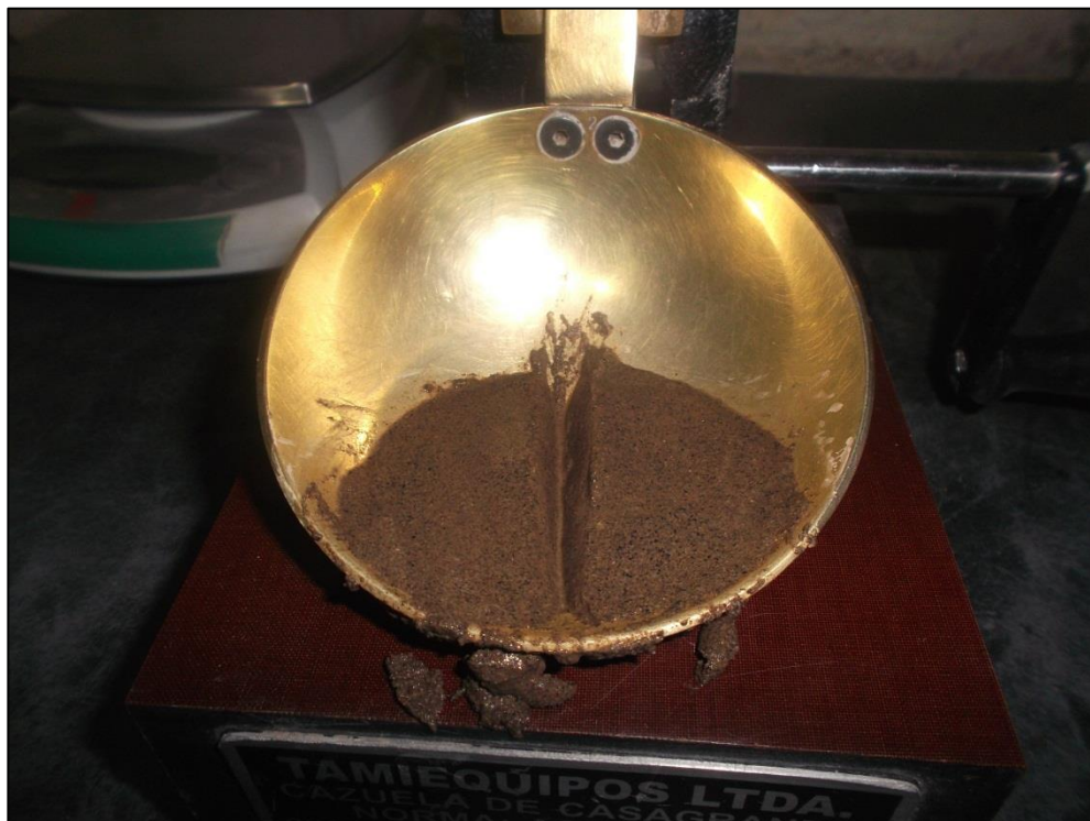
Figura 5-4: Ensayo de Límite Líquido en la cuchara de Casagrande, se muestra la unión antes de los 10 golpes.
