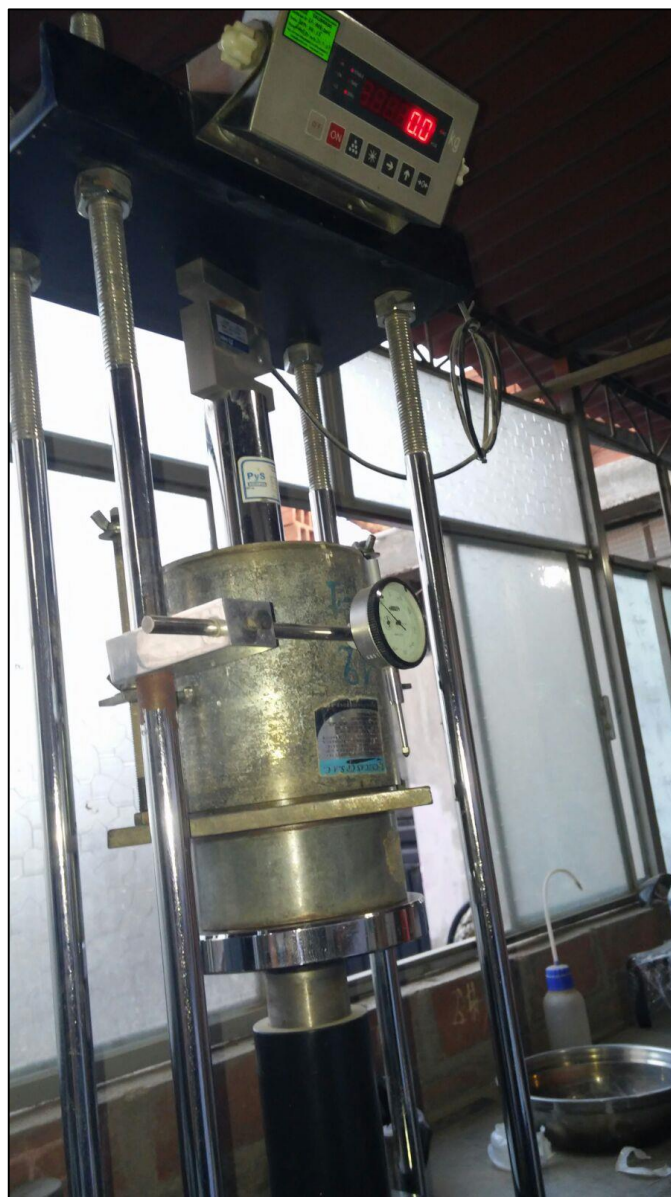
Figura 5-26: colocado de la muestra luego de sumergirla por 72 horas en la maquina CBR
