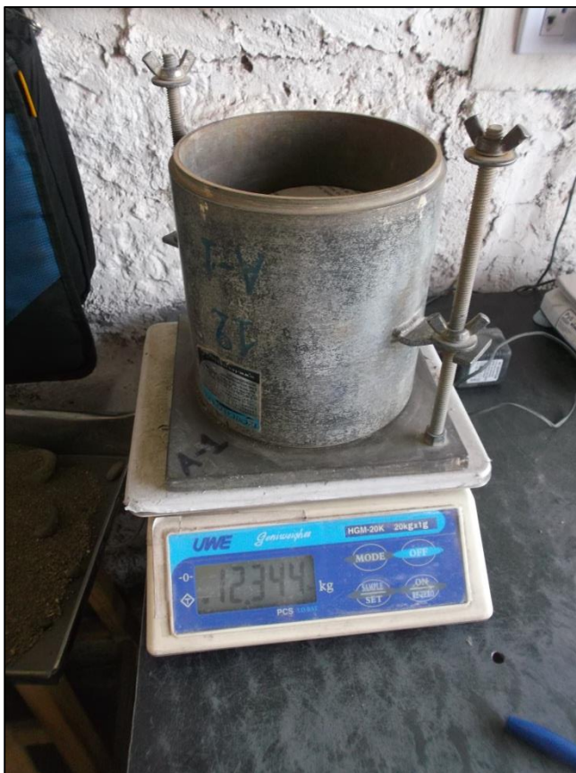
Figura 5-23: peso de la muestra compactada a la humedad óptima
