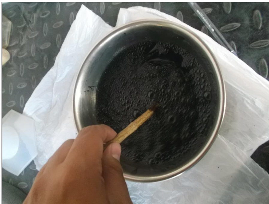
Figura 5-28: mezclado del líquido estabilizador
