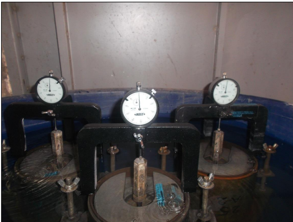
Figura 5-25: colocación y medición inicial de la expansión
