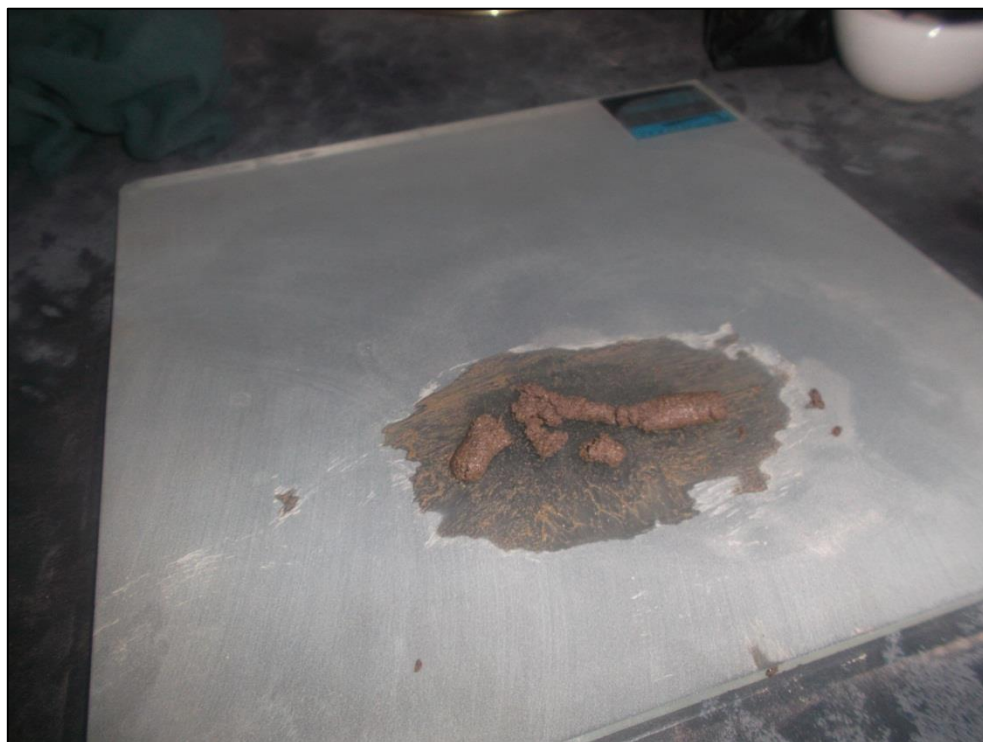
Figura 5-9: Muestra totalmente fracturada, desprendida y en partes.
