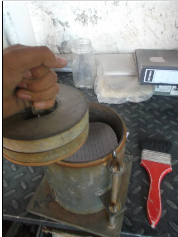
Figura 5-24: colocación de las pesas en el molde
