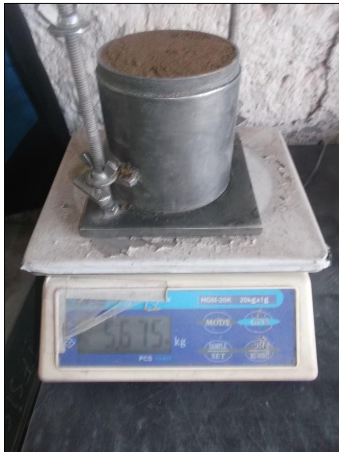
Figura 5-15: Molde Compactado, enrasado y pesado
