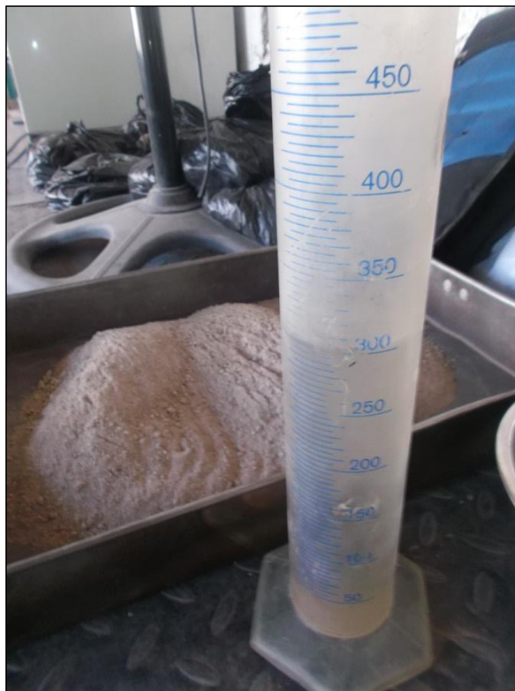
Figura 5-11: Cantidad de agua a añadir y mezclar con la muestra
