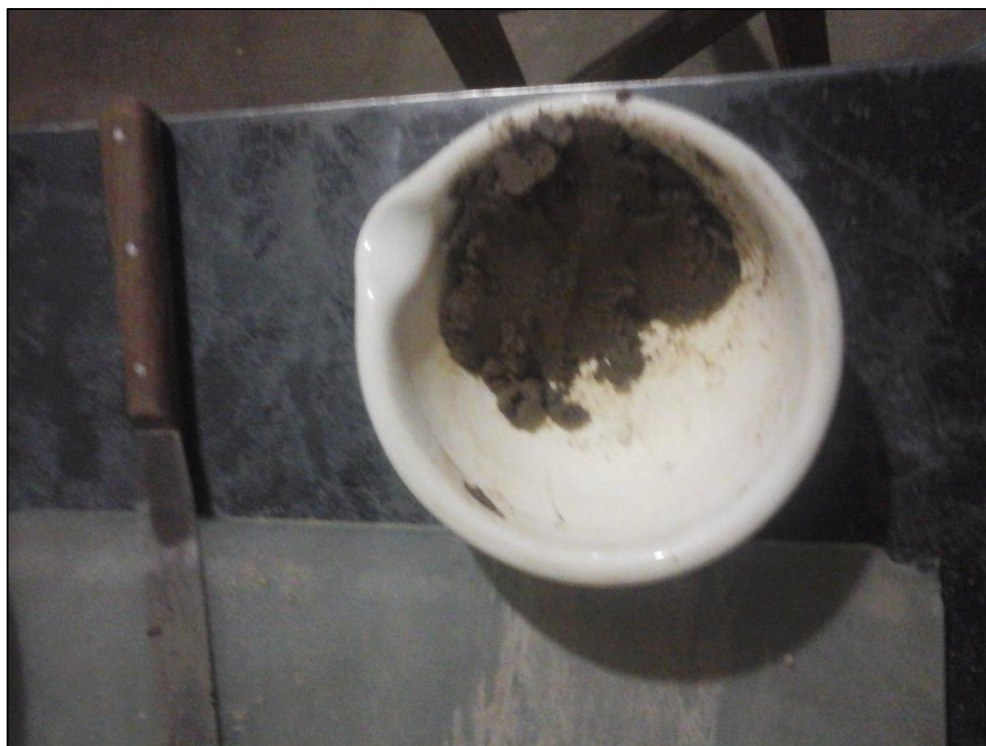
Figura 5-6: Muestra representativa para el ensayo de Limite Plástico
