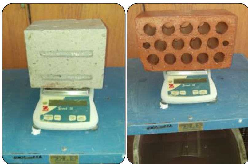
Figura 6.13 Ensayo de densidad de unidades: Registro del peso de unidades luego de la ebullición
