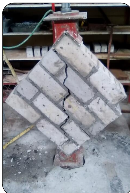
Figura 7.6 Falla en murete de unidades de sillar (Mortero 1:1:4)
