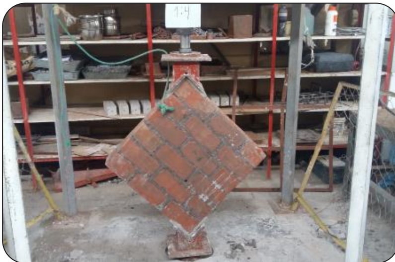
Figura 7.3 Ensayo de resistencia a compresión diagonal de muretes: Ladrillo H-10
