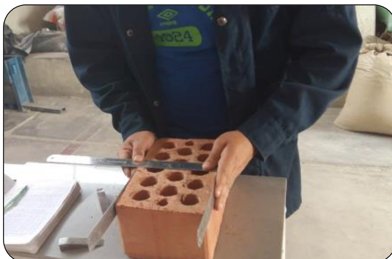
Figura 6.2 Toma de medidas: Ladrillo H-10
