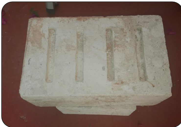
Figura 4.3 Unidad de sillar terminada
