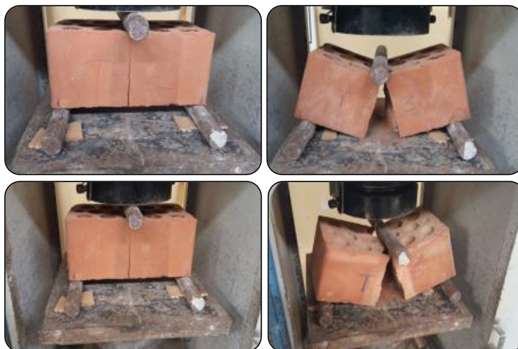
Figura 6.19 Ensayo de tracción por flexión: Ladrillo H-10
