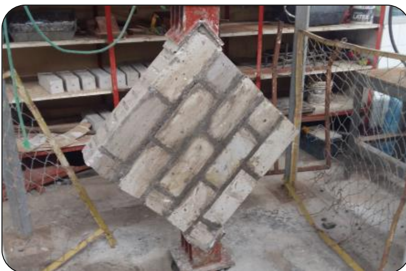
Figura 7.4 Ensayo de resistencia a compresión diagonal de muretes: Unidad de sillar
