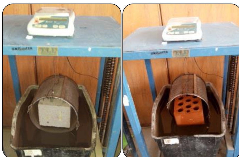
Figura 6.14 Ensayo de densidad de unidades: Registro del peso sumergido de unidades
