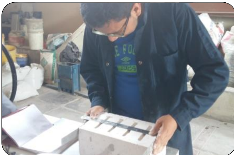
Figura 6.1 Toma de medidas: Unidad de sillar
