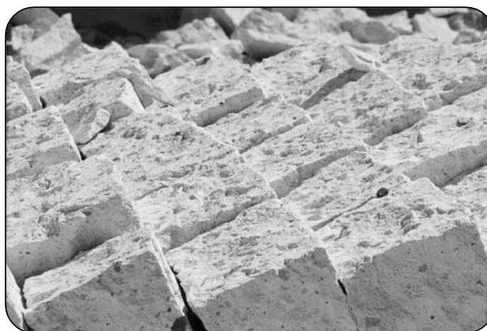
Figura 2.10 Bloques de sillar de 55x32x20 cm
