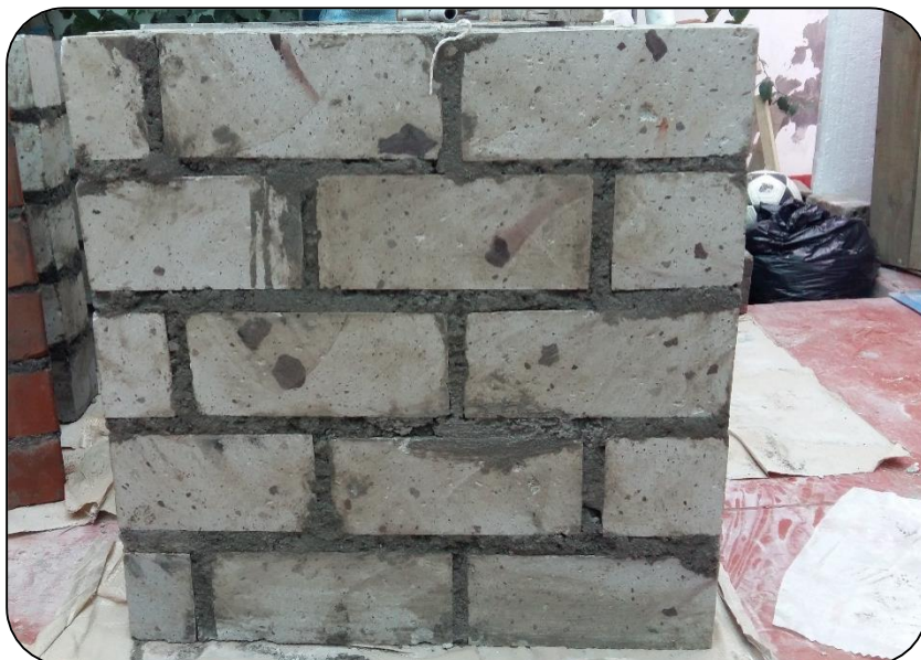
Figura 5.8 Muretes de albañilería: Unidad de sillar
