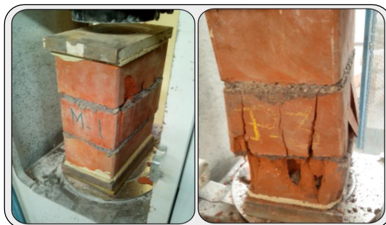
Figura 7.2 Ensayo de resistencia a compresión de prismas: Ladrillo H-10
