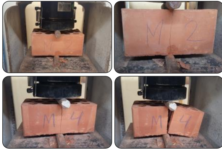
Figura 6.22 Ensayo de tracción indirecta: Ladrillo H-10
