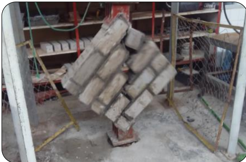
Figura 7.5 Falla escalonada en murete de unidades de sillar (Mortero 1:4)
