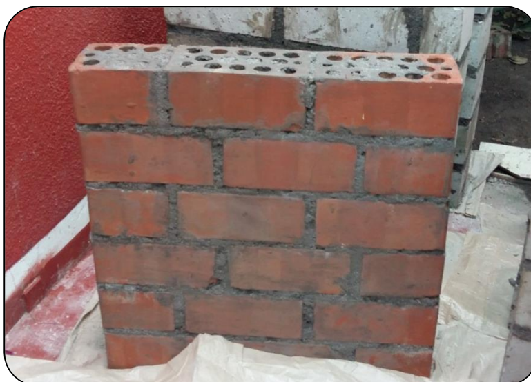
Figura 5.6 Muretes de albañilería: Ladrillo H-10
