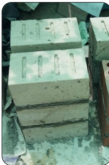
Figura 5.7 Prismas de albañilería: Unidad de sillar
