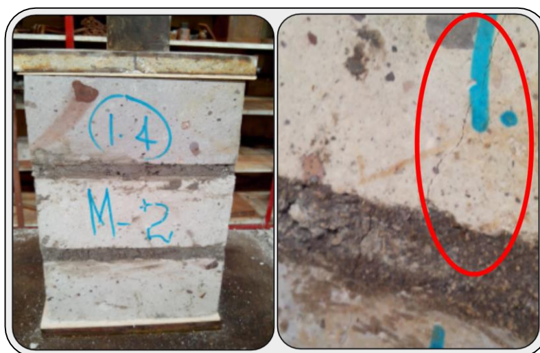
Figura 7.1 Ensayo de resistencia a compresión de prismas: Unidades de sillar
