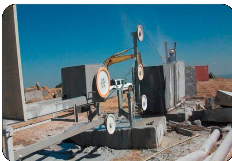
Figura 8.7 Equipo de hilo de corte con hilo diamantado con más de 02 poleas
