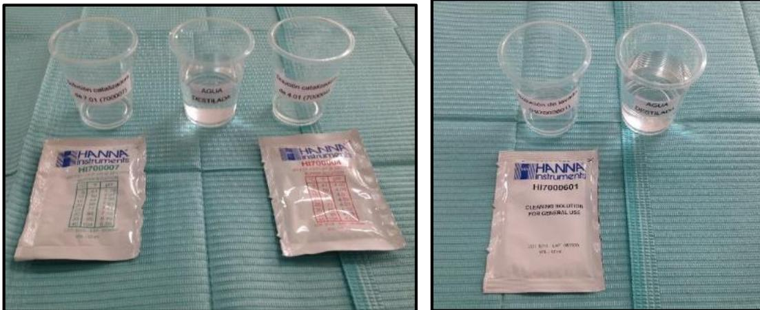
Se procedió a la calibración del pHmetro HI98100 Checker Plus, entre solución catalizadoras se utilizó agua destilada para limpiarlo.
