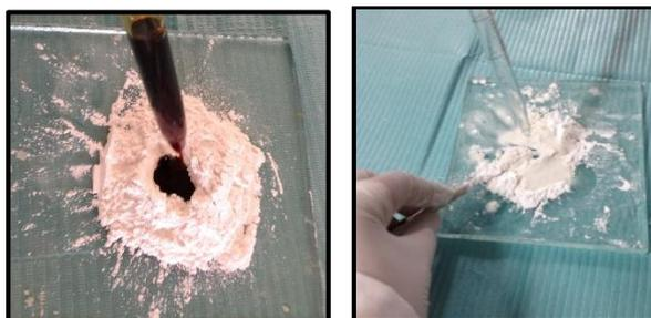
Mezclar hasta tener una pasta homogénea y medir con el phmetro, y se procedió a colocarlo a la Ficha de Recolección de Datos.
