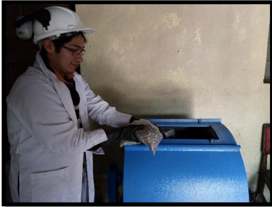
VISTA 10: COLOCADO DEL MATERIAL A LA MAQUINA DE LOS ANGELES
