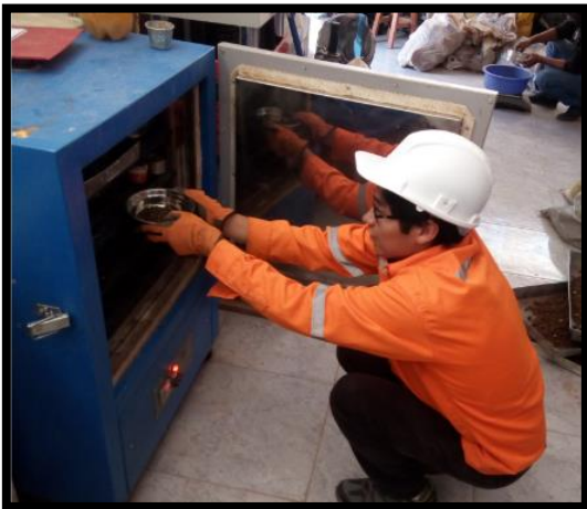
VISTA 6: COLOCADO AL HORNO FINO Y GRUESO
