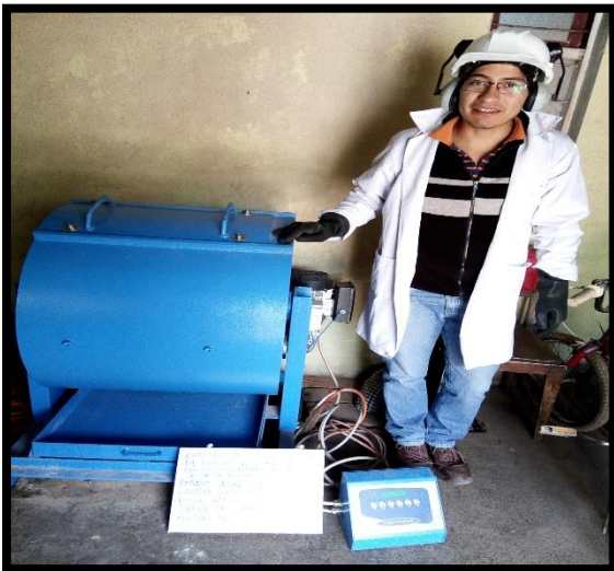
VISTA 11: DESGASTE DEL MATERIAL
