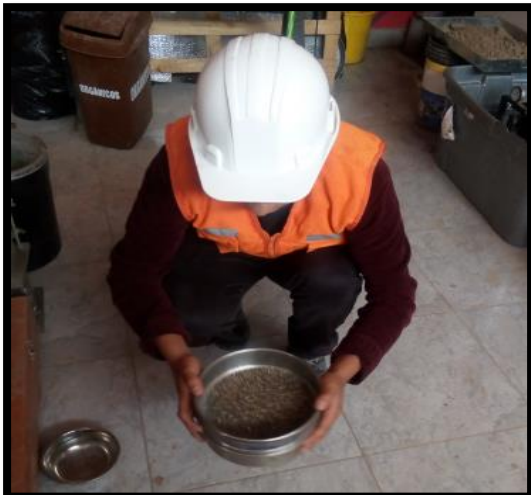
VISTA 4: TAMIZADO AGREGADO FINO
