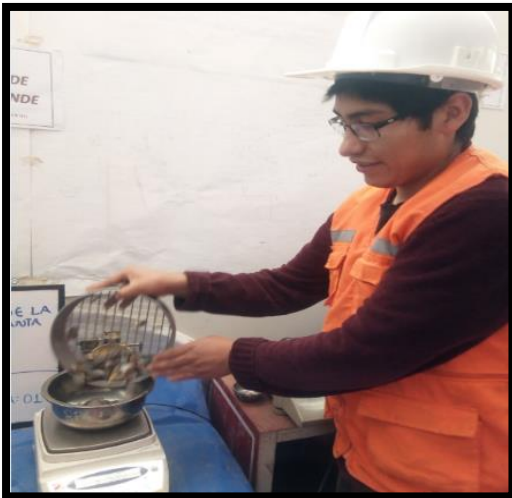
VISTA 3: PESADO DEL AGREGADO GRUESO
