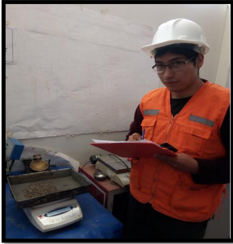
VISTA 2 PESADO DEL AGREGADO FINO
