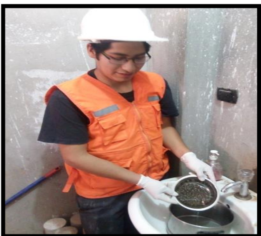
VISTA 8: LAVADO DE MATERIAL FINO Y GRUESO DESPUES DE SECADO
