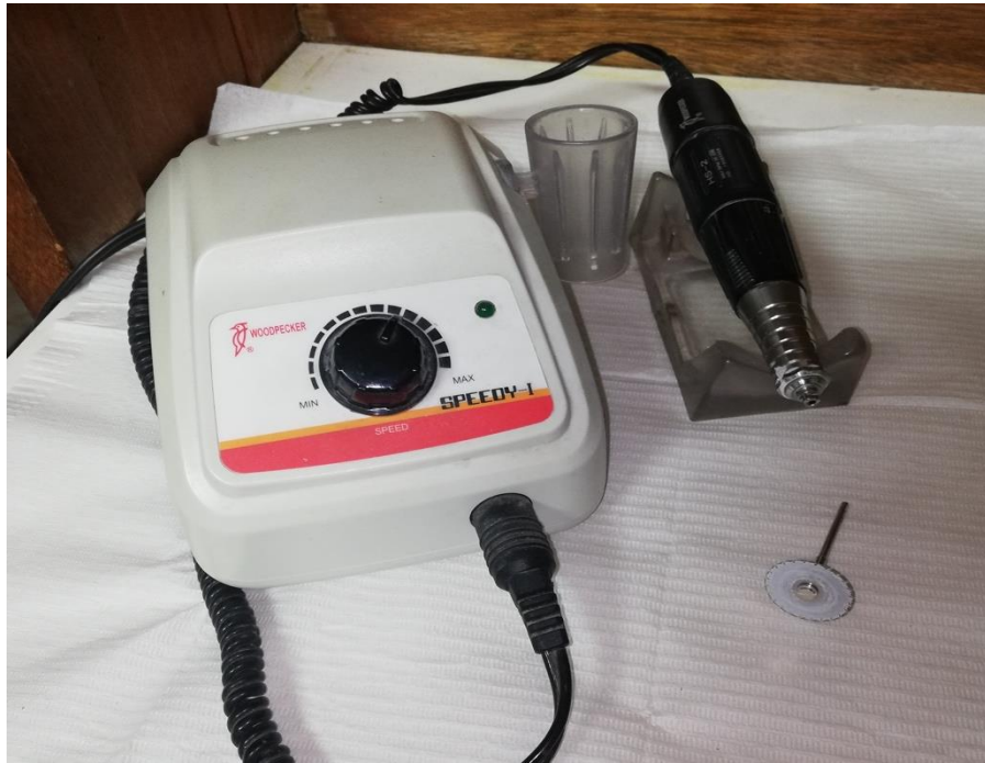
Figura Nº 9: Micromotor Speedy 1 Woodpecker y discos de corte
