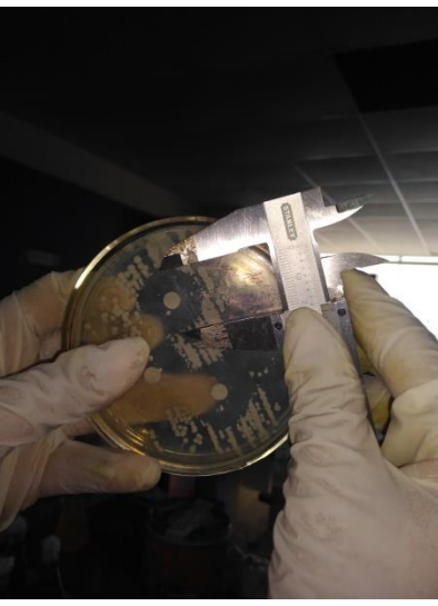
Se miden los halos de inhibición con un vernier.
