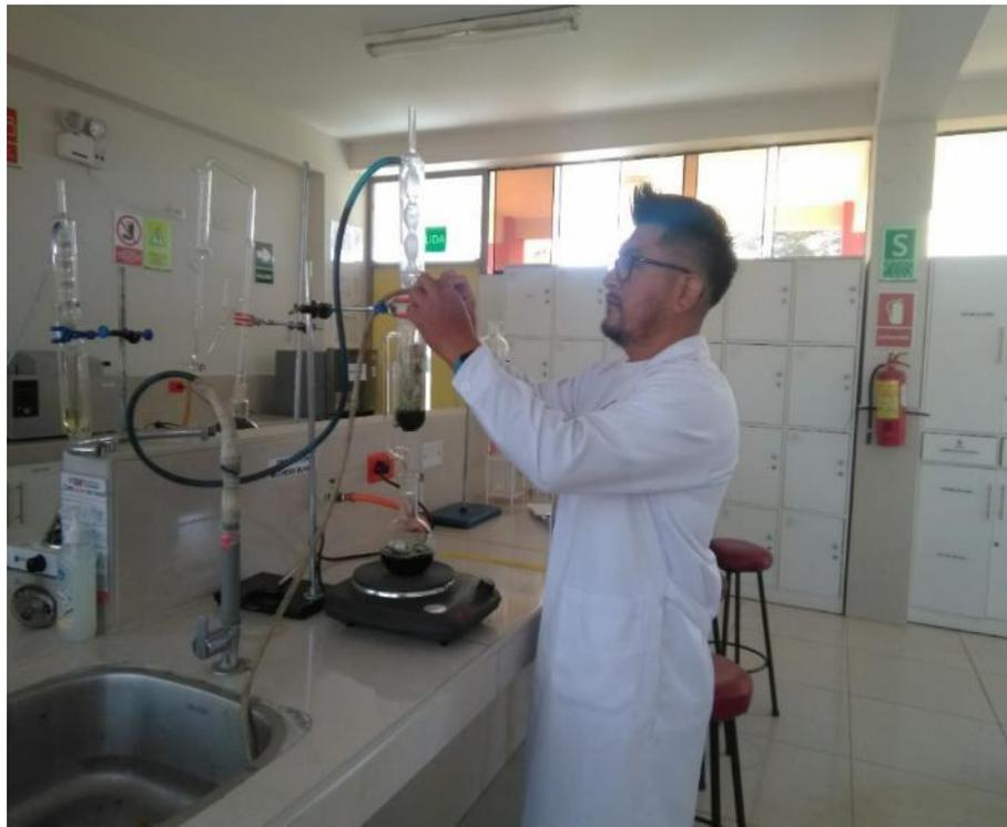
Figura 7: extracción por equipo Soxhlet
