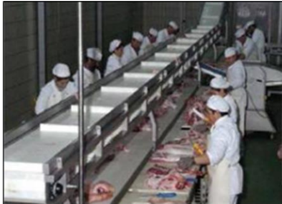
Imagen N°49: Mesa de distribución
