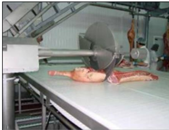
Imagen N° 47: mesa de despiece (sierra de corte)
