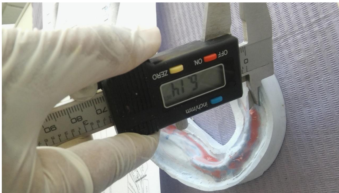
IMAGEN 18: Uso del vernier para registrar la altura posterior izquierda del reborde residual con el diámetro interno.
