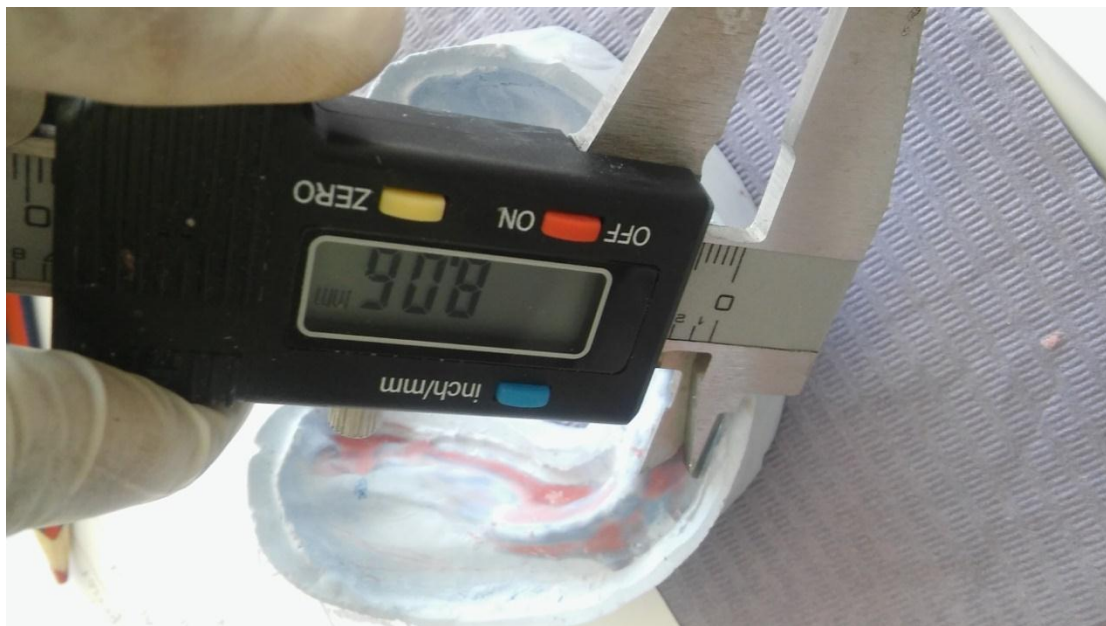
IMAGEN 16: Uso del vernier para registrar la altura anterior del reborde residual con el diámetro interno.
