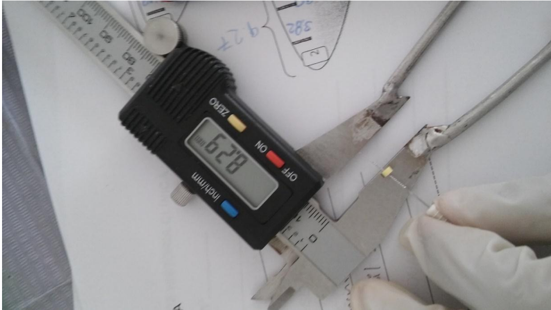
IMAGEN 15: Uso del vernier para registrar la altura tomada por la lima.
