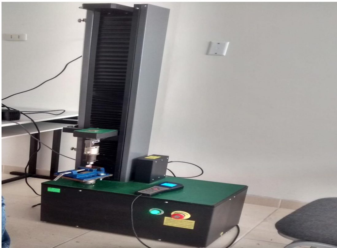
Foto N° 20: Máquina digital de ensayos universales CMT-5L.
