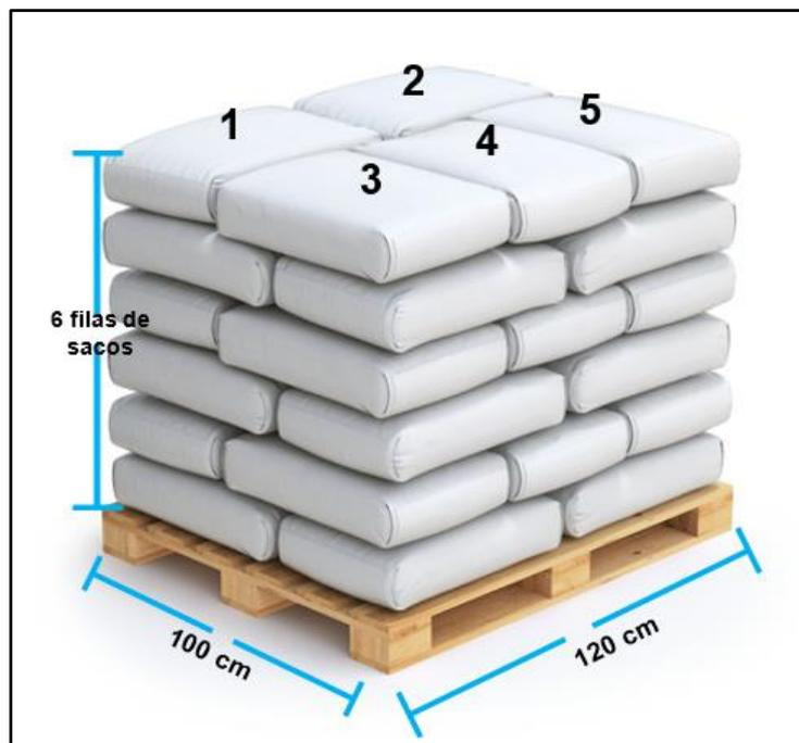
*Nota: La Figura Muestra El Plano De Estiba, Coresa (2022)*
