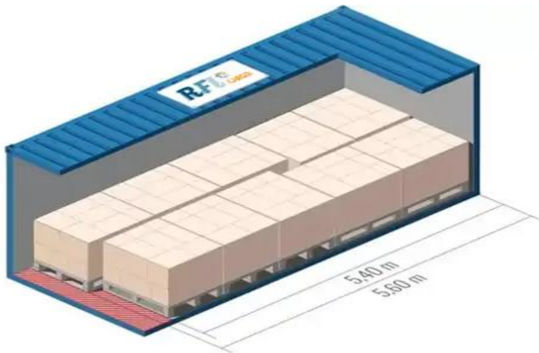
Figura 10. Plano de estiba del contenedor
