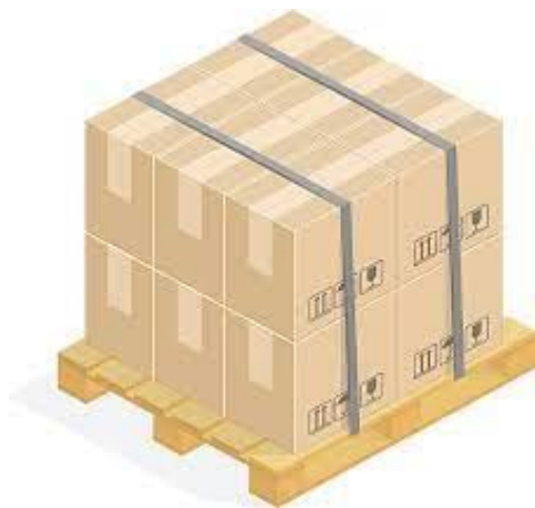
Figura 9. Modelo de paletizado
