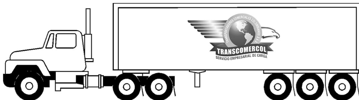
*Nota.* Tractocamión de 3 ejes, con semirremolque de 3 ejes. Fuente: prueba de ruta, link: <https://www.pruebaderuta.com/clasificacion-vehiculos-carga.php>
