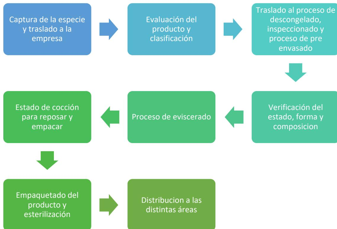
La figura 1 evidencia un ejemplo de flujograma del proceso para recolectar y procesar atún.
