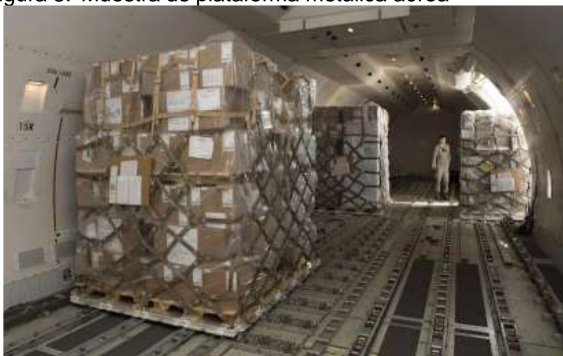
Figura 8. Muestra de plataforma metálica aérea
