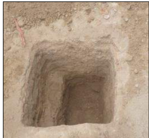
Ilustración 7.- calicatas de exploración subterránea
