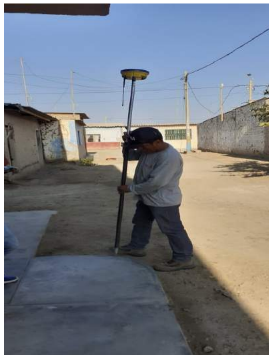
Ilustración 18.-Lectura de puntos en la zona de trabajo.
