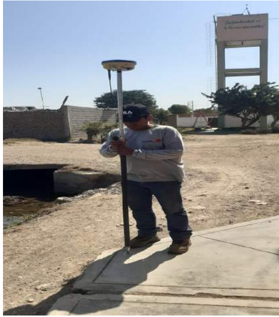
Ilustración 19.-Lectura de auxiliar 2.con GPS DIFERENCIAL.
