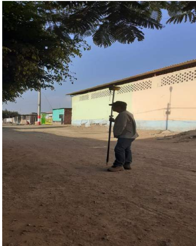
Ilustración 20.- Lectura de puntos en carretera con GPS DIFERENCIAL ACNOVO GX9.
