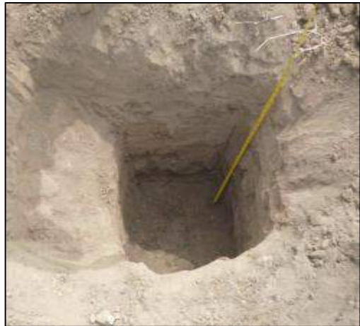
Ilustración 9.- calicatas de exploración subterránea.
