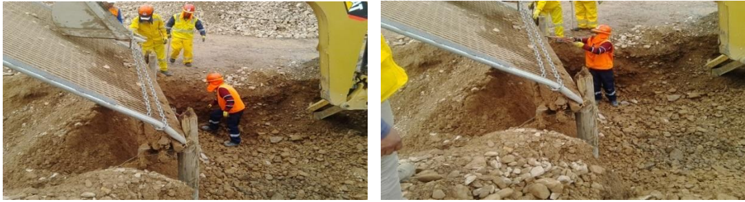
Figura 29 : Acumulación y zarandeo de material en canteras
