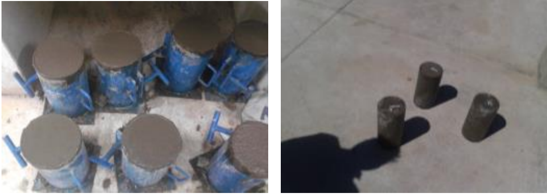
Figura 38 : Testigos de concreto
