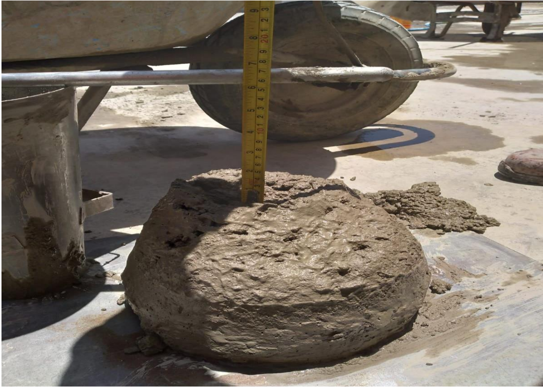
Fotos 9: Asentamiento de Slump sikament tm 120 de 1 hora y media
