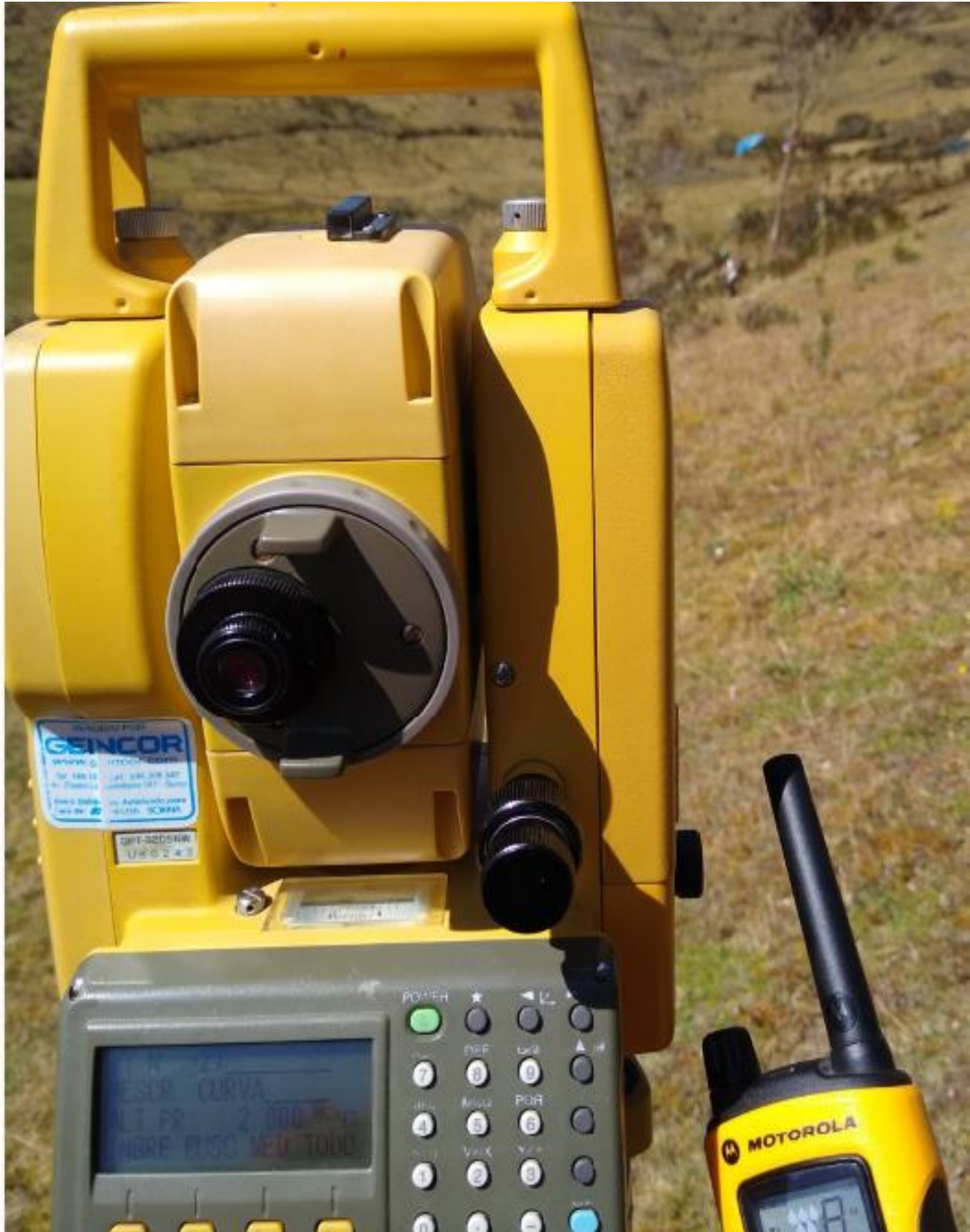
Foto 4 EQUIPO TOPOGRAFICO ESTACION TOTAL
