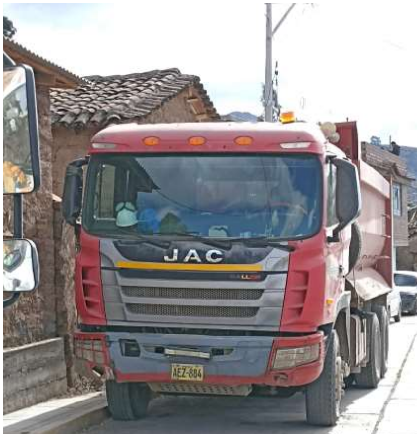
Figura 24. Volquete 02 para el traslado de ladrillos.
