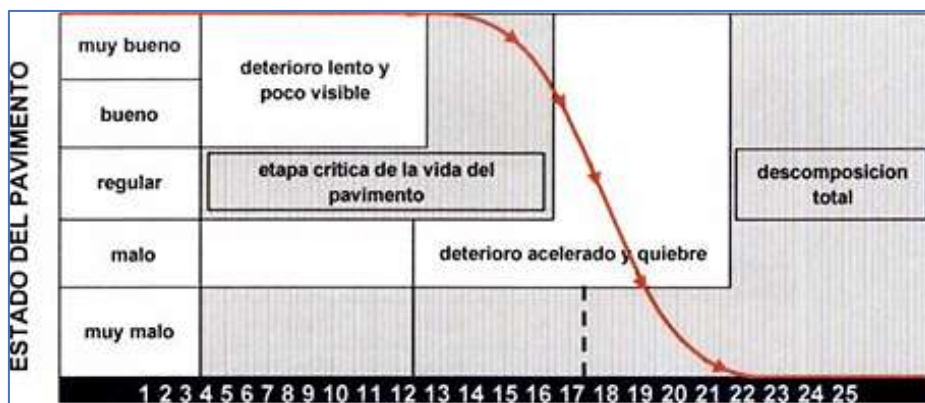
Figura N° 56: Vida del pavimento (miles de ejes equivalentes o años) Fuente: Elaboración Propia, en base a datos de la Guía AASHTO '93
