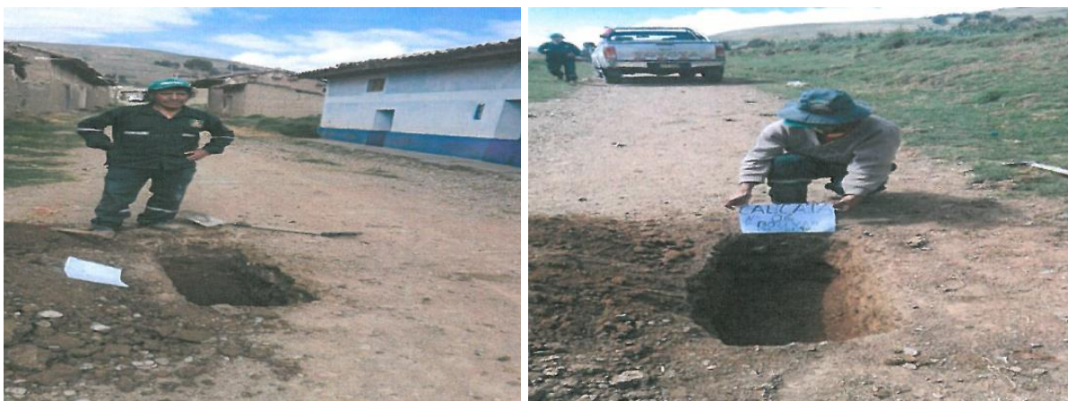
Imagen N° 3: Extracción de Muestras
