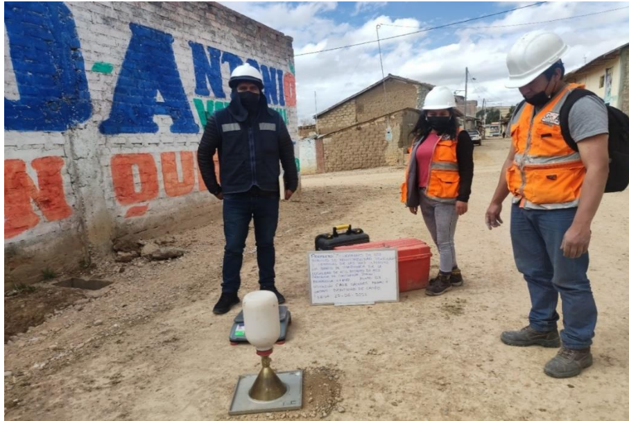
IMAGEN N° 22: Ensayo de Densidad de Campo de la Sub base
