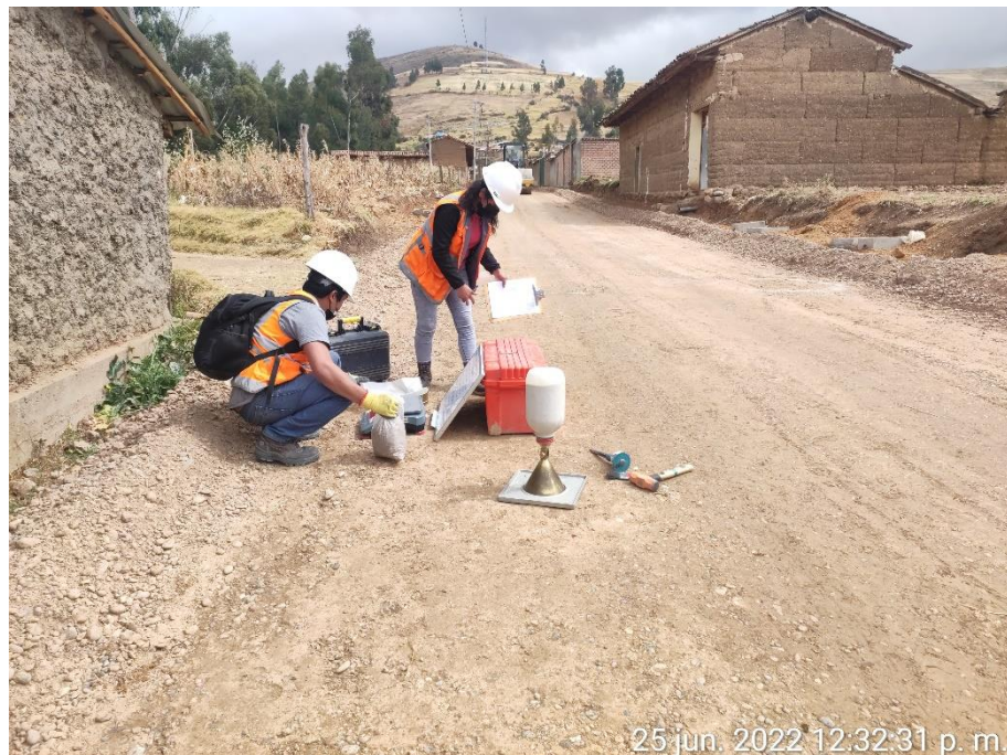
IMAGEN N° 17: Ensayo de Densidad de campo en la Subrasante
