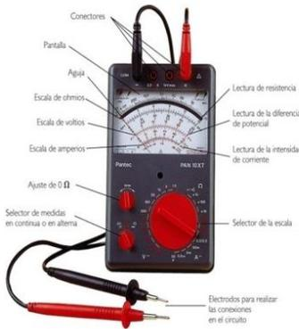
Un voltímetro es aquel aparato o dispositivo que se utiliza a fin de medir, de manera directa o indirecta, la diferencia potencial entre dos puntos de un circuito eléctrico.
