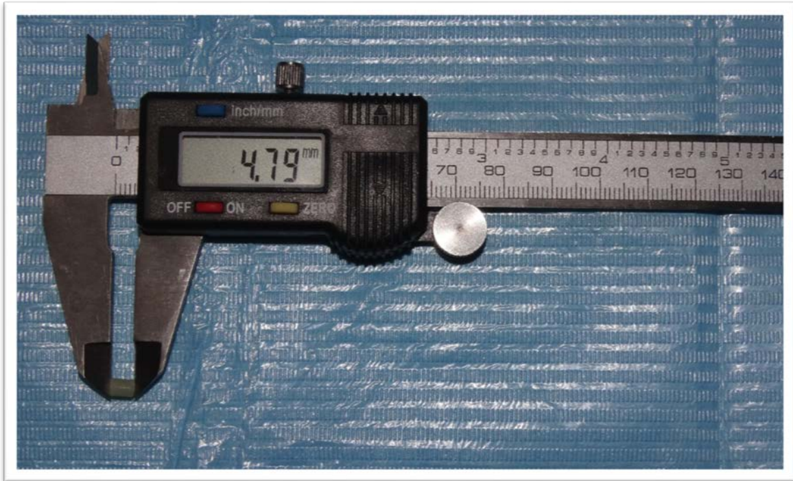
Muestra 5 Profundidad de polimerización 2.39
