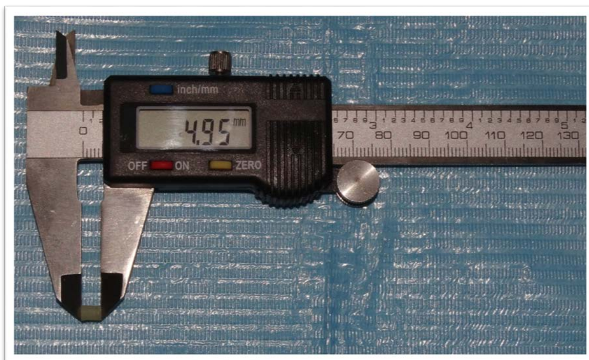
Muestra 4 Profundidad de polimerización 2.47
