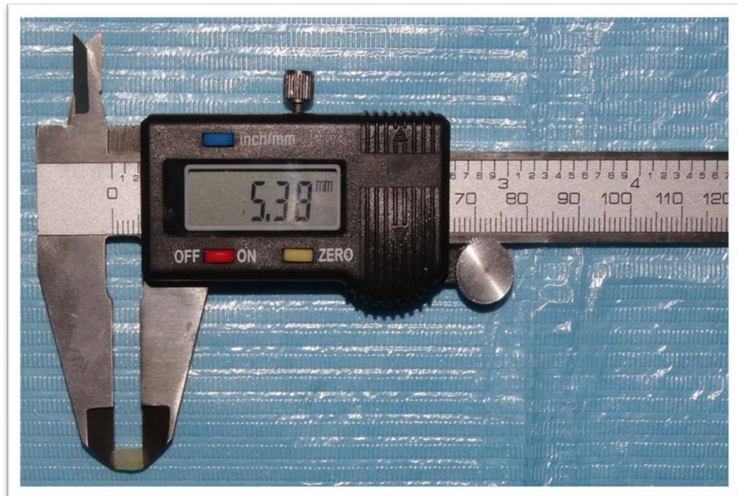
Muestra 8 Profundidad de polimerización 2.69
