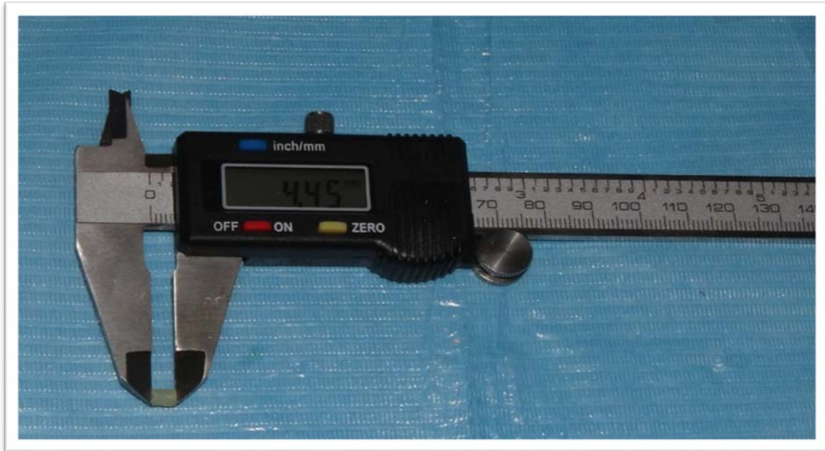
Muestra 1 Profundidad de polimerización 2.22
