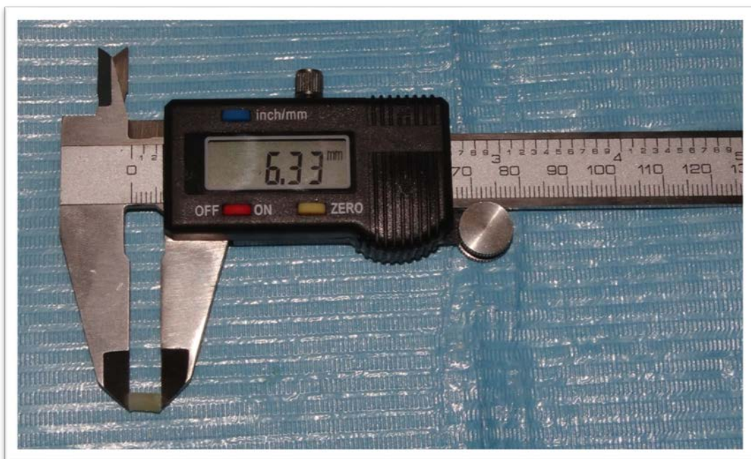
Muestra 2 Profundidad de polimerización 3.16
