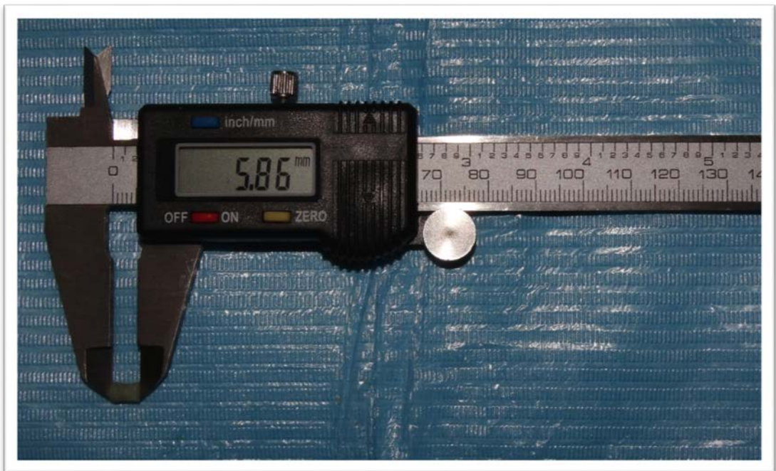
Muestra 6 Profundidad de polimerización 2.93
