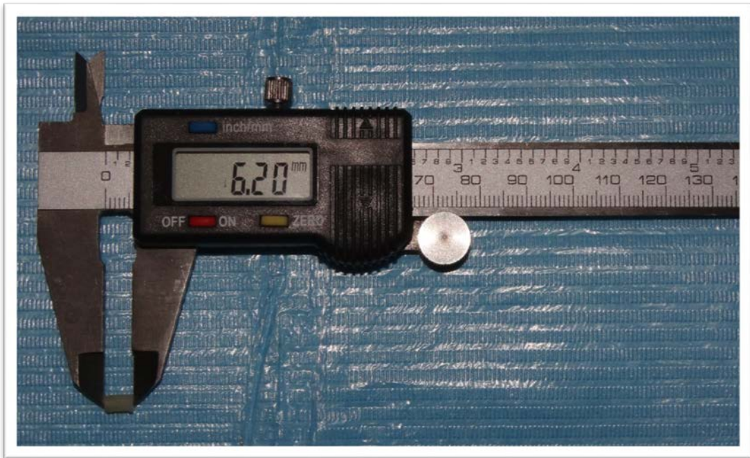
Muestra 7 Profundidad de polimerización 3.10
