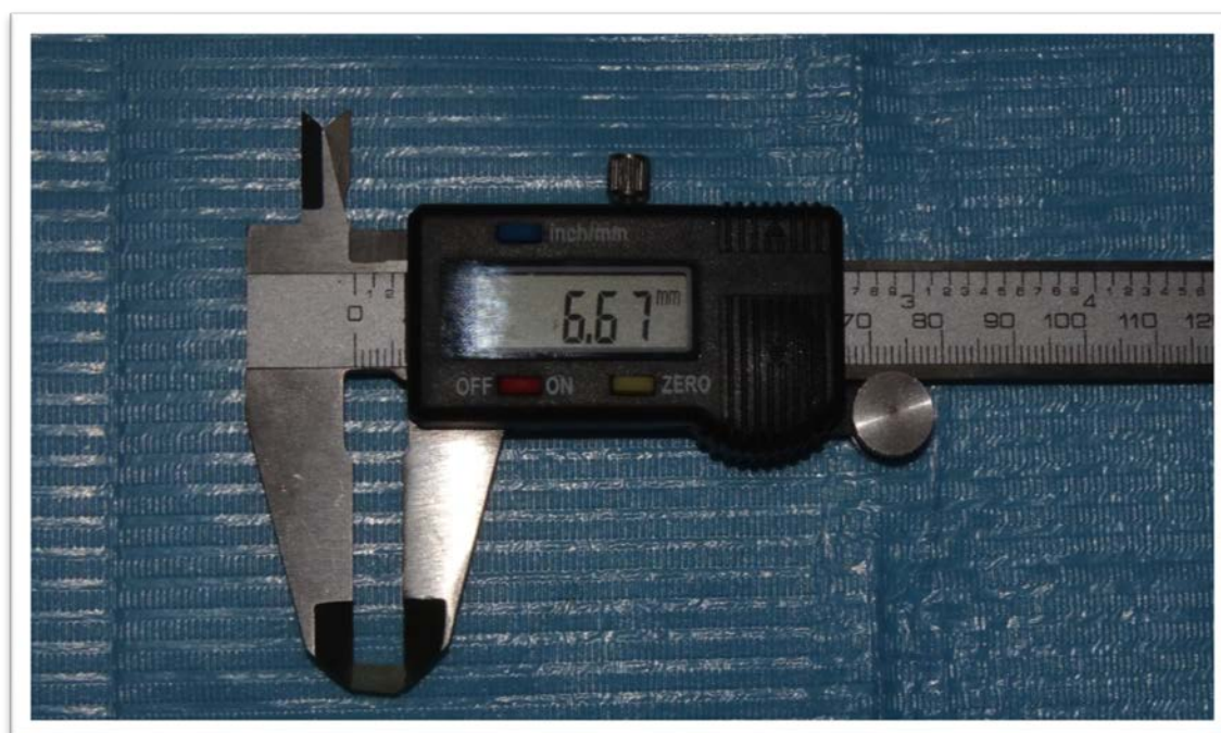
Muestra 10 Profundidad de polimerización 3.33
