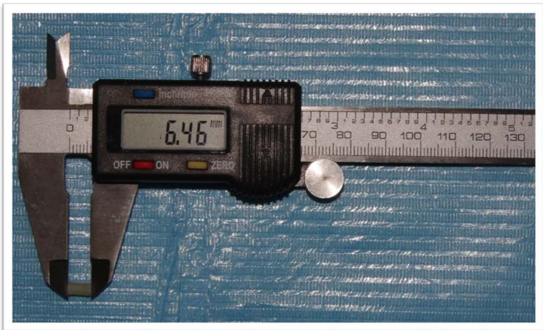
Muestra 8 Profundidad de polimerización 3.23
