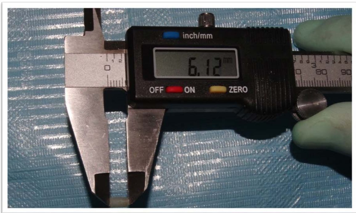
Medida de la altura absoluta con un micrómetro.
