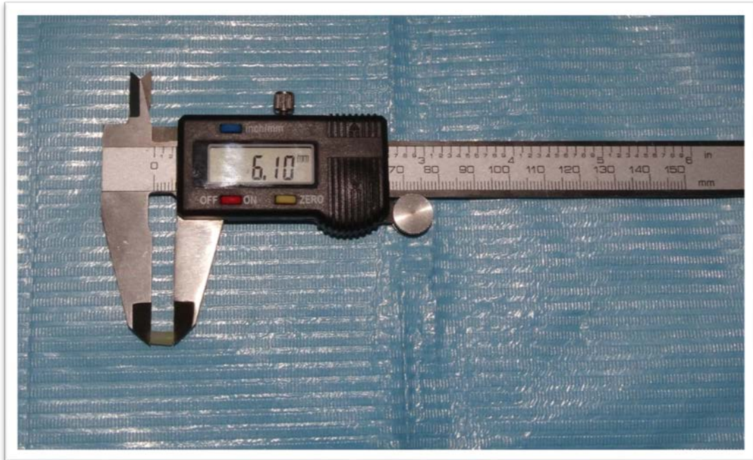
Muestra 1 Profundidad de polimerización 3.05
