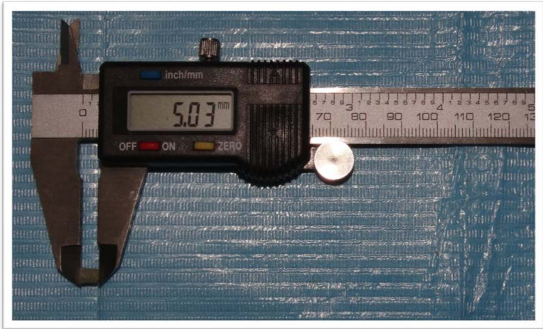
Muestra 5 Profundidad de polimerización 2.51
