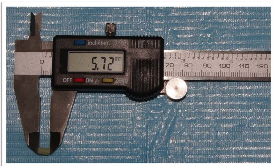
Muestra 2 Profundidad de polimerización 2.86
