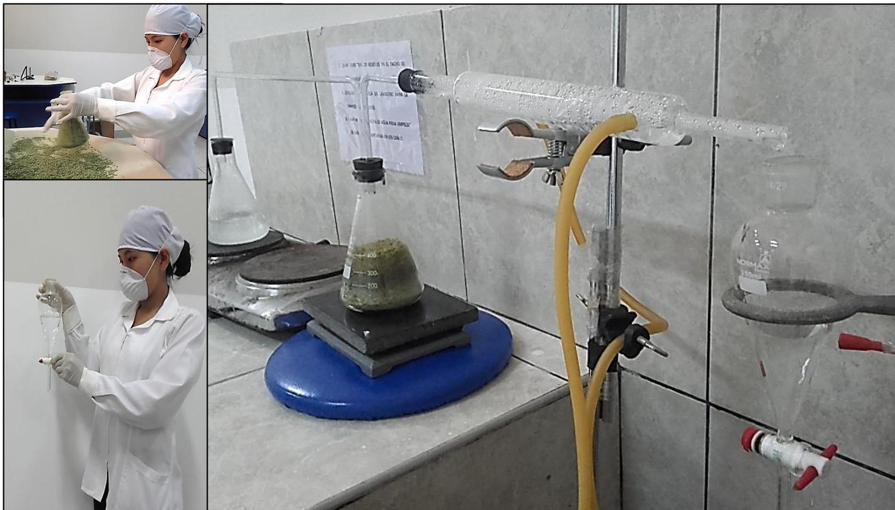
Para la extracción del aceite esencial del *Origanum vulgare* L. “orégano”, se dio a partir de 12 kg (hoja secas), las cuales fueron sometidas a destilación con arrastre de vapor, en un equipo de destilación de vidrio.
