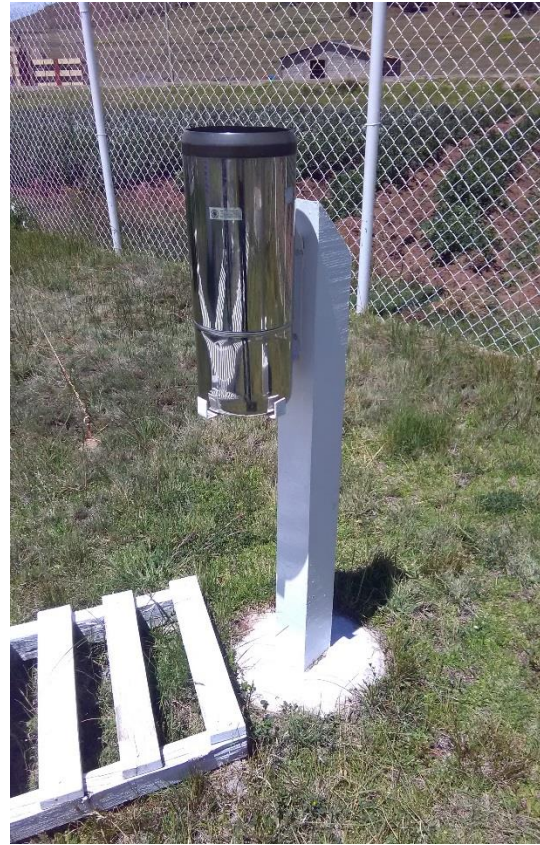
Figura 2. Esquema de pluviómetro (a), equipo pluviométrico en Capachica (b). Fuente: Elaboración propia en base a esquema en libro de Chereque (a), foto con permiso de SENAMHI-Puno (b).
