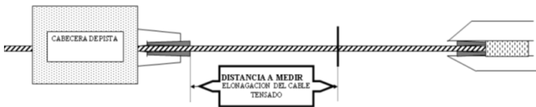
FIGURA 87: DISTANCIA A MEDIR – ELONGACIÓN DEL CABLE TENSADO.
