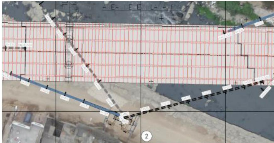
FIGURA 93: POSICIÓN 02 DE LA GRÚA TELESCÓPICA PARA EL MONTAJE DESDE EL MARGEN IZQUIERDO DEL RIO (PILAR I).
