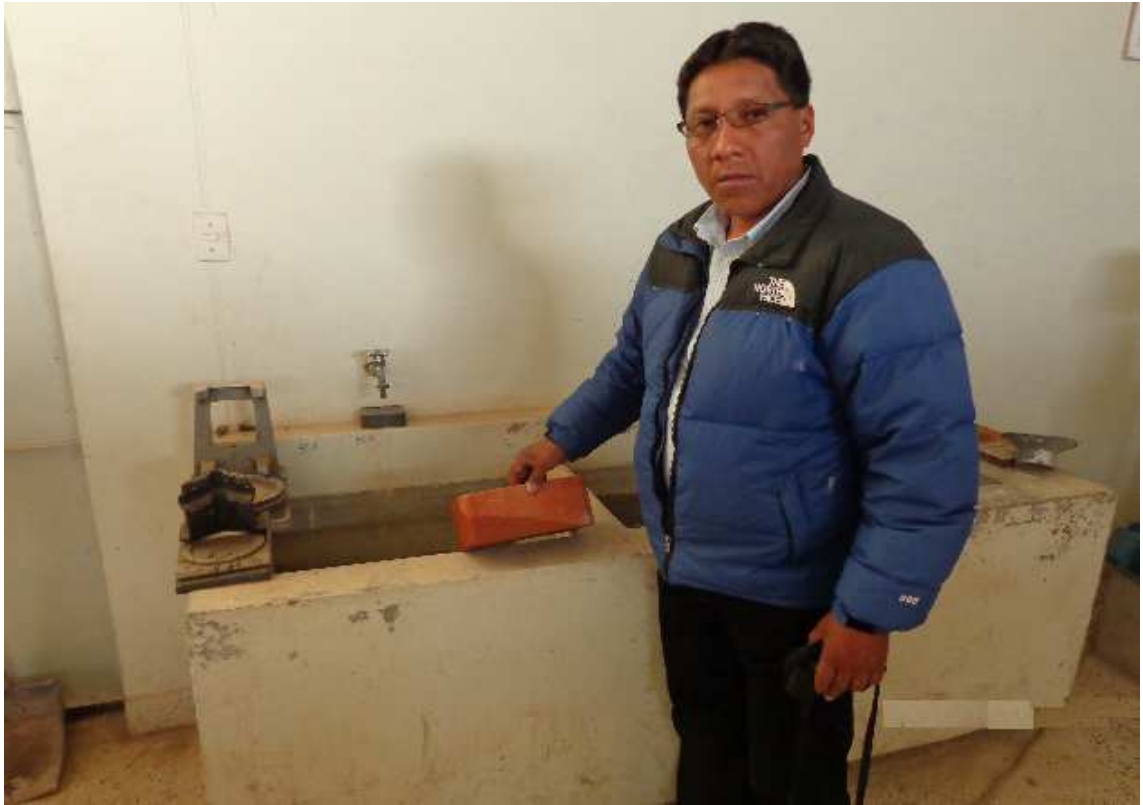
Figura 14: Saturación de muestra ladrillo king kong para hallar la absorción del ladrillo artesanal
