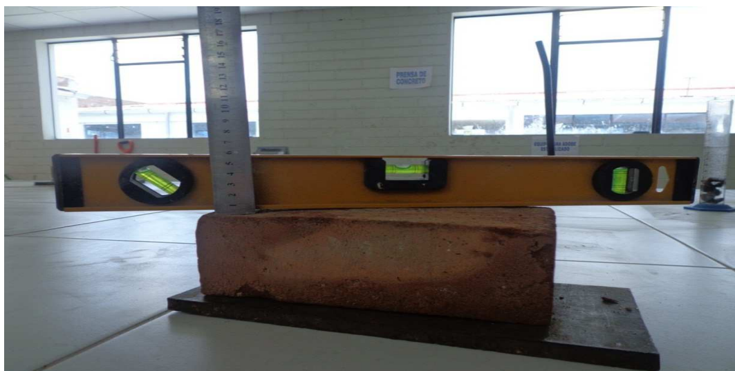
Figura 16: Medida de alabeo superficial convexa de la muestra artesanal tipo king kong
