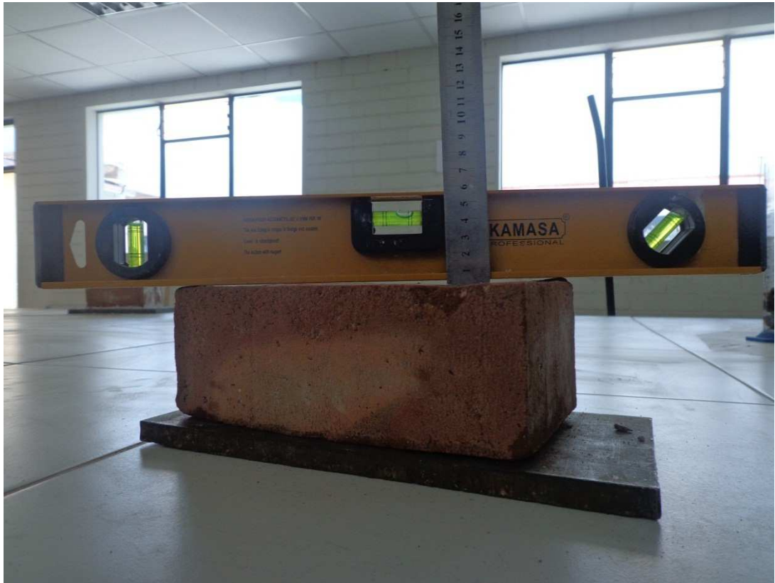
Figura 22: Medición con instrumentos de precisión de ladrillo king kong para determinar alabeo de muestra
