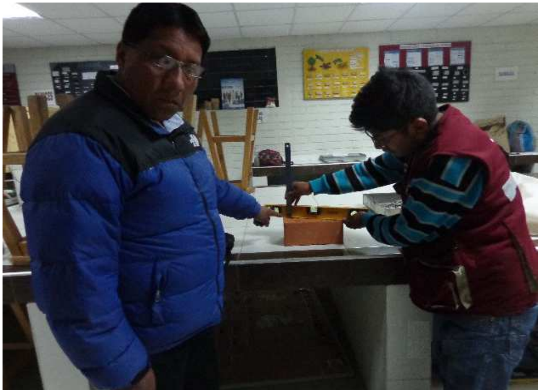
Figura 21: Muestra de ladrillo king kong sometido a prueba de alabeo
