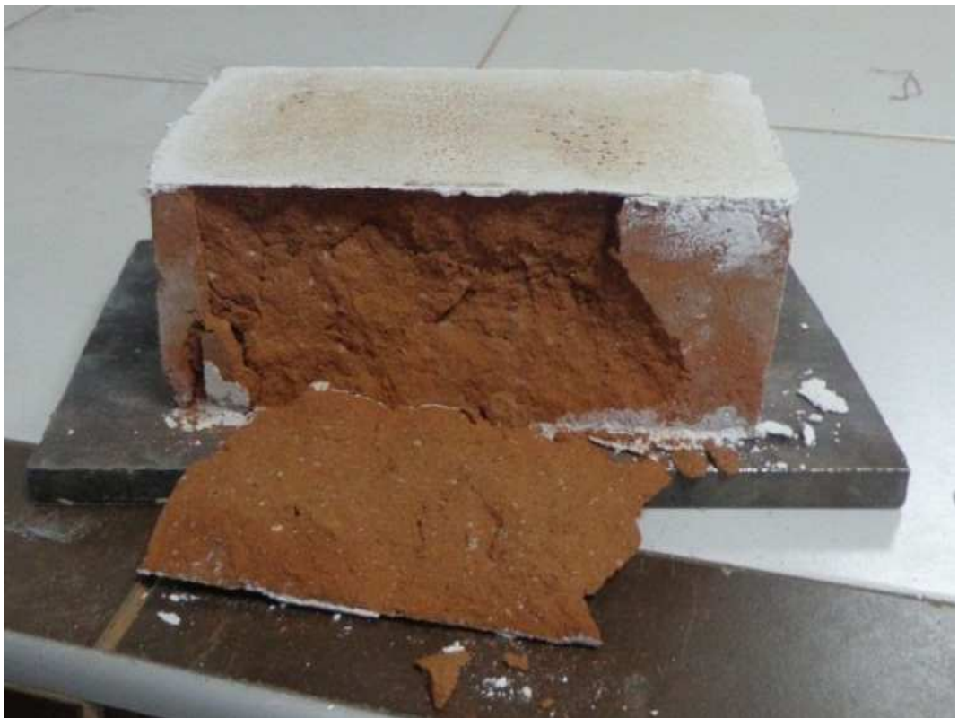
Figura 13: Resultado de muestra después de aplicado fuerza de resistencia a la compresión
