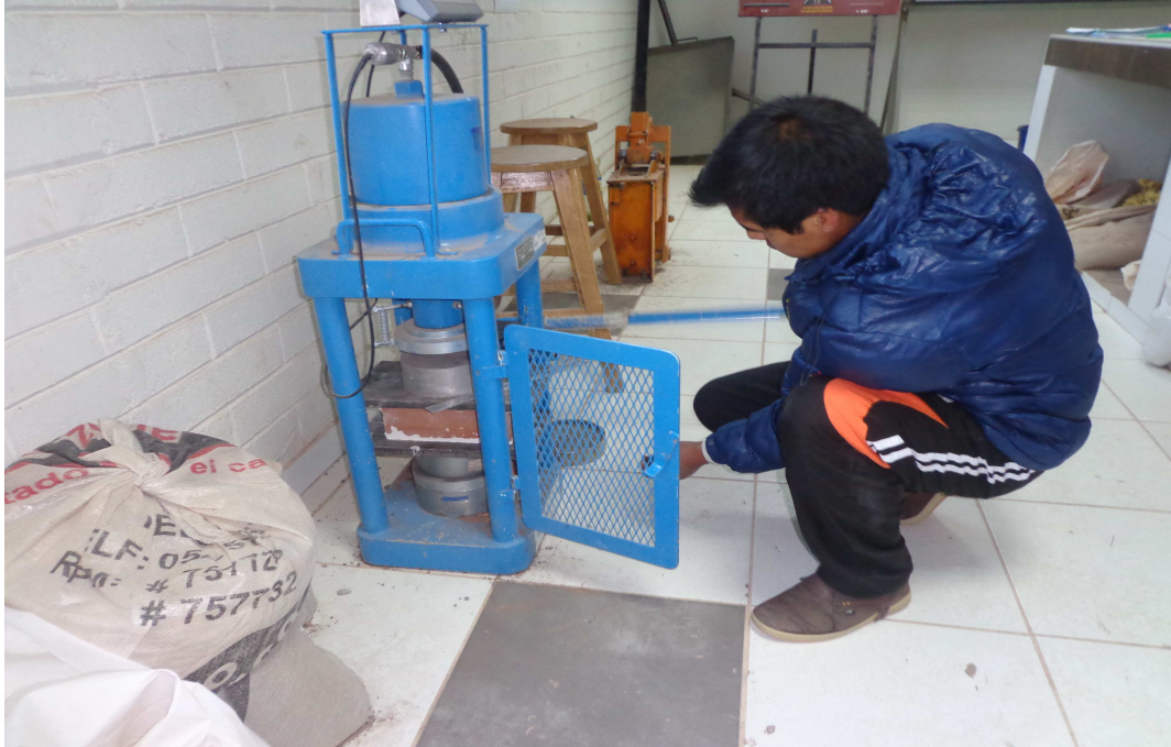
Figura 11: Ubicación de la muestra en la máquina de compresión
