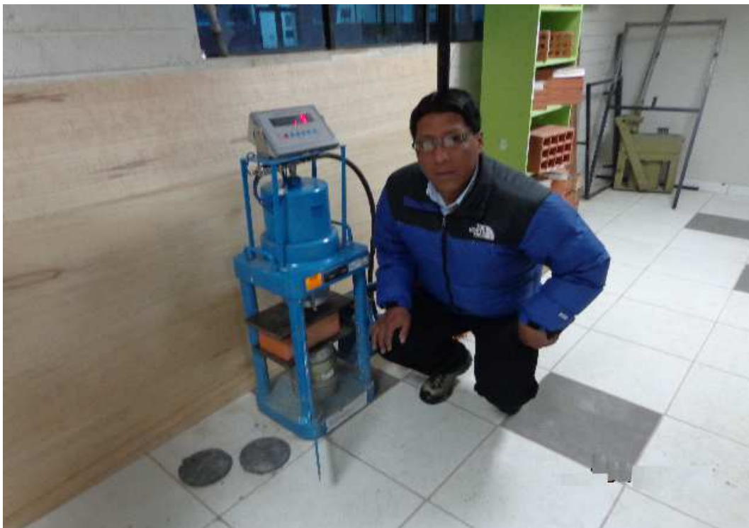
Figura 12: Aplicación fuerza a la muestra para la resistencia a la compresión simple
