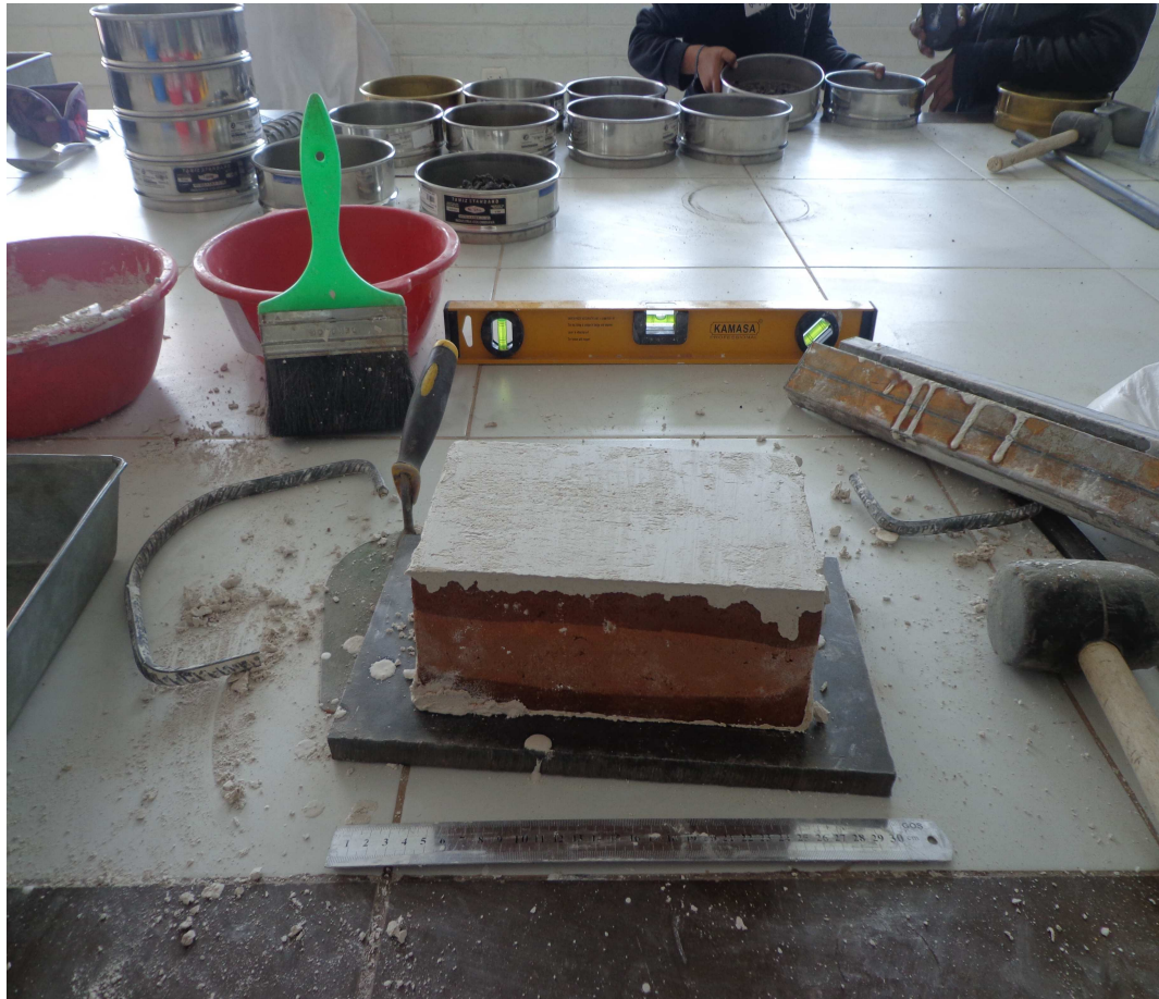
Figura 10: Refrentado de muestra para la resistencia a compresión
