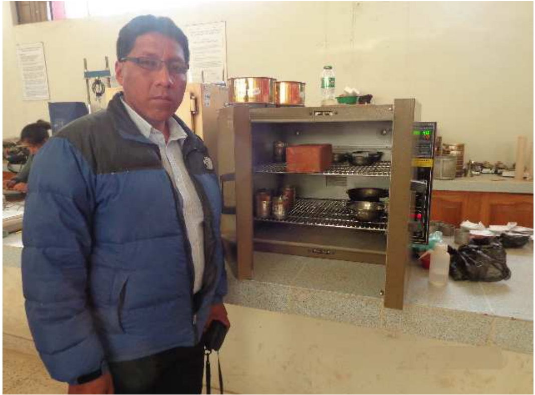
Figura 19: Horno eléctrico empleados para el secado de las muestras de ladrillos artesanales king kong
