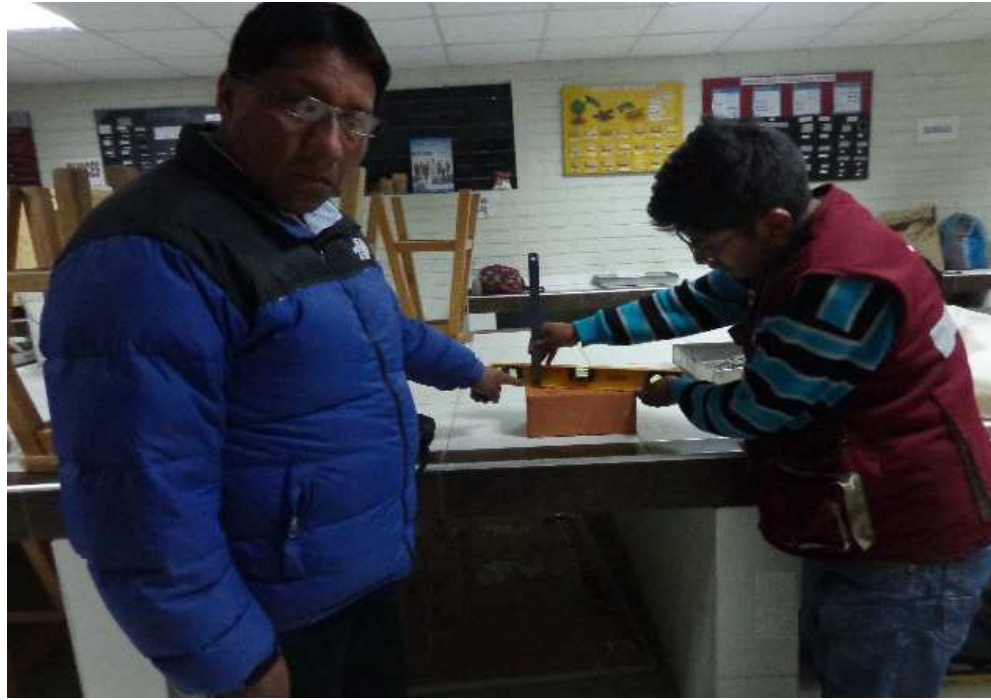
. Figura 15: Medida de alabeo superficial cóncava de la muestra artesanal tipo king Kong
