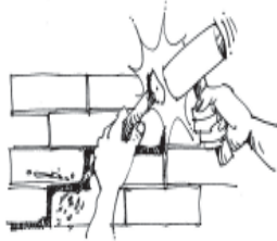
Imagen N°07 Eliminación de mortero en juntas
