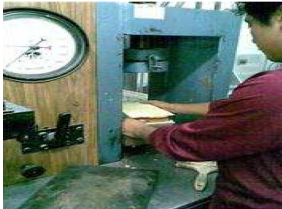
Imagen N°38 colocación del espécimen en la prensa Fuente: Tesis Evaluación De La Resistencia A La Compresión De Ladrillo Autor: José Luis Hernández
