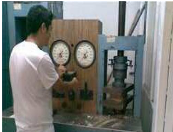
Imagen N°41 Compresión del espécimen Fuente: Tesis Evaluación De La Resistencia A La Compresión De Ladrillo Autor: José Luis Hernández Hernández
