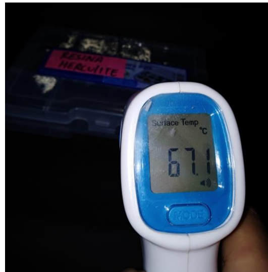
Figura N° 22: Incrustaciones sumergidas a temperaturas elevadas.
