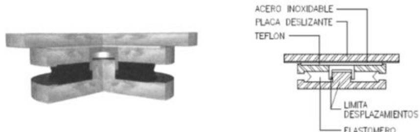
Figura 2 - 41: Corte Aislador Tipo Friccional
