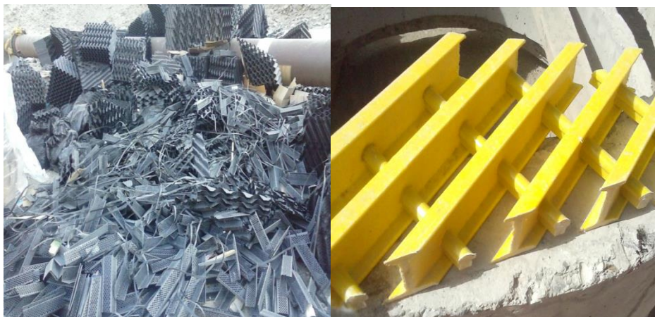
Figura N° 06: Restos de plásticos y grating de fibra de vidrio.
