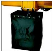
Opcional: Contenedor de cadena flexible fabricado con material textil de alta resistencia.
