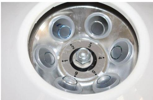
28. Tubos de ensayo en centrifuga, 2000 rpm durante 10min.
