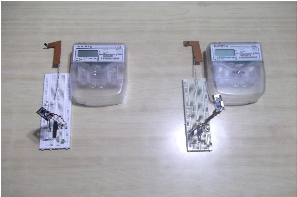
Foto 2 Elementos de los módulos del medidor remoto
