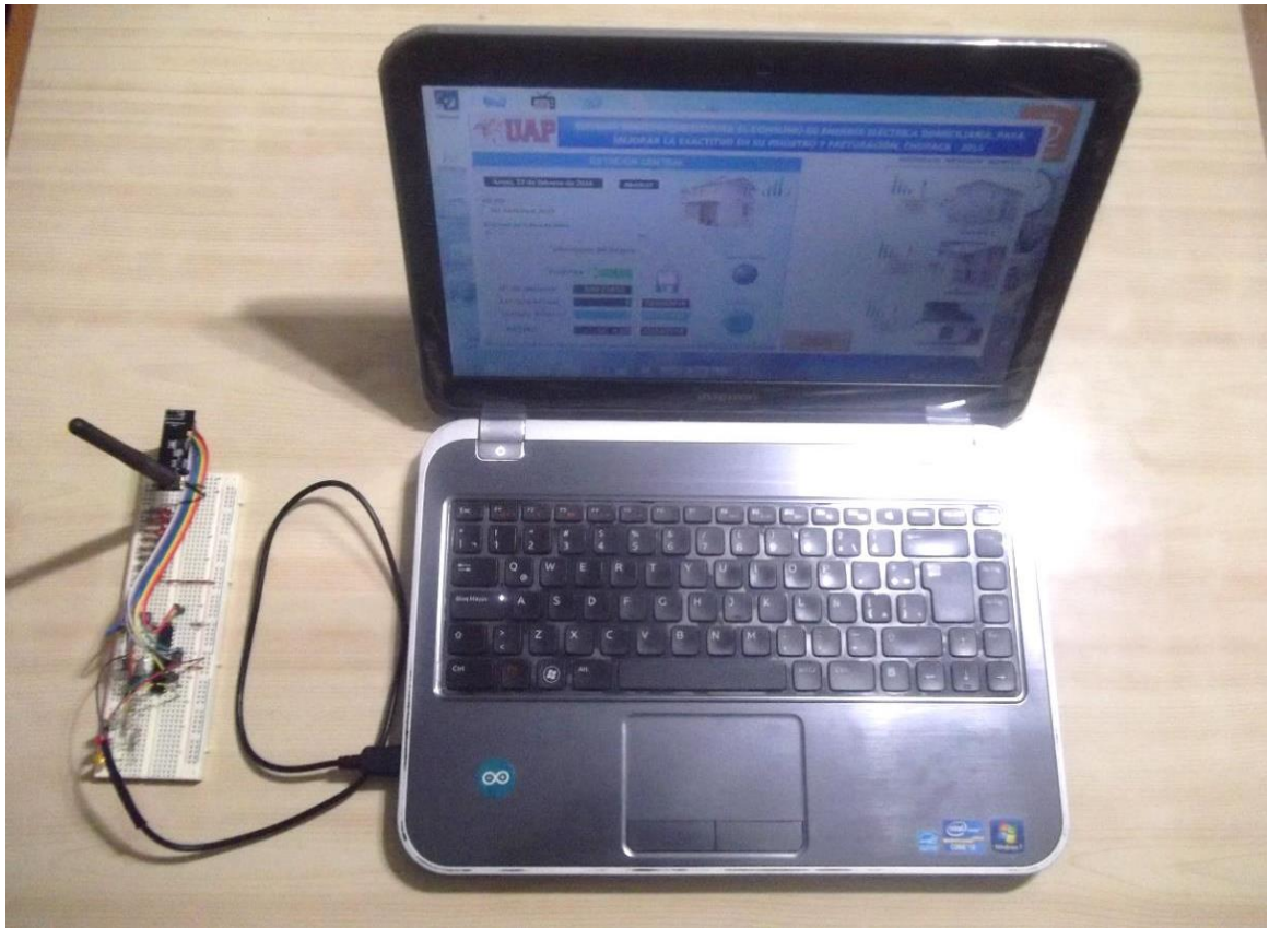
Foto 5 Pruebas de transmisión del consumo del medidor a la estación central
