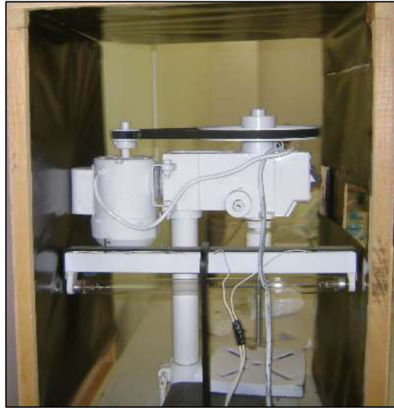
Figura 5 Equipo para agitación constante y protección de los rayos UV
