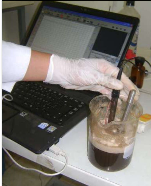
Figura 7 Equipo con Sensores de Temperatura y pH
