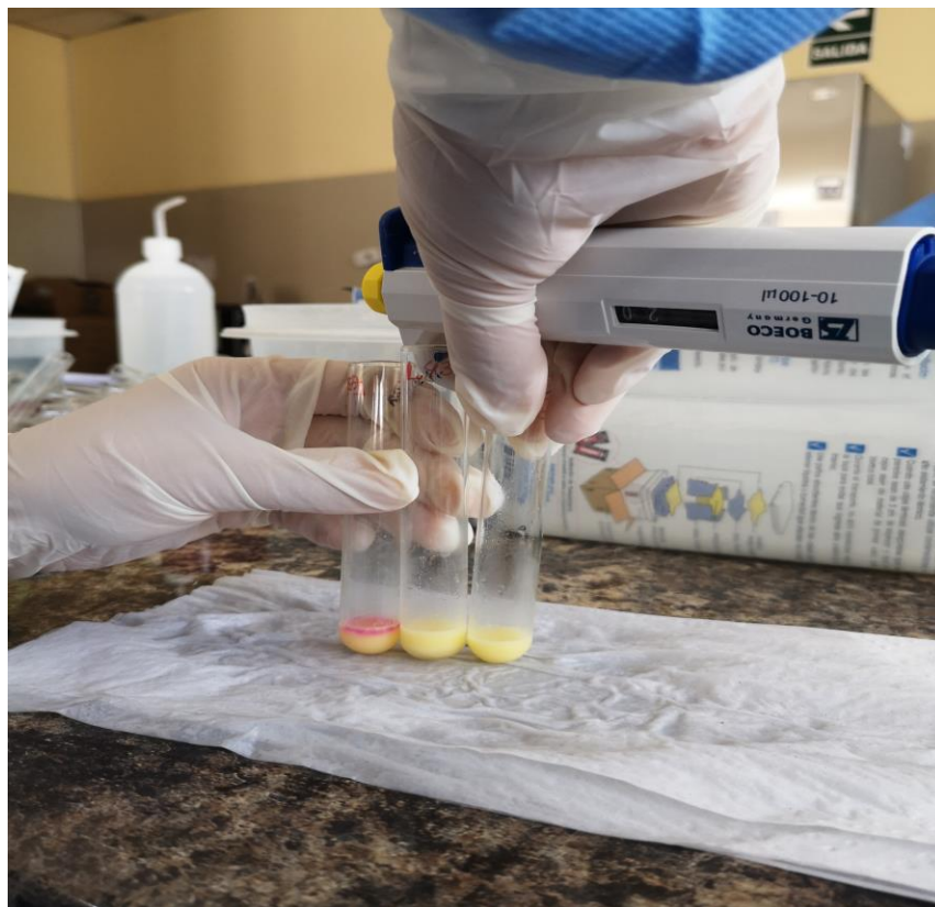
Fotografía 14. Agregar 1 gota de Feniltaleina al 1%.y 20 ul de NaOH.
