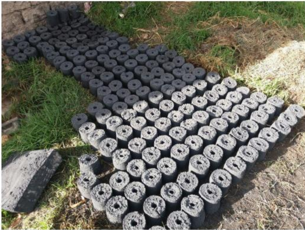
Figura 13. Briquetas de carbón usadas para la quema del ladrillo.
