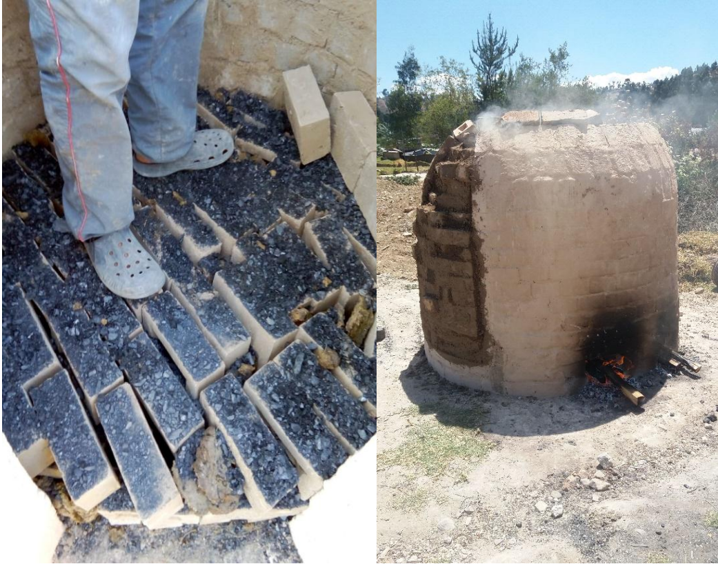
Figura 66. Carga de ladrillo y quemado. Fuente: Elaboración Propia, 2018.
