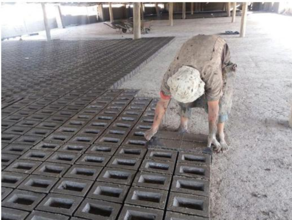
Figura 10. Tendido de ladrillo en ramada.
