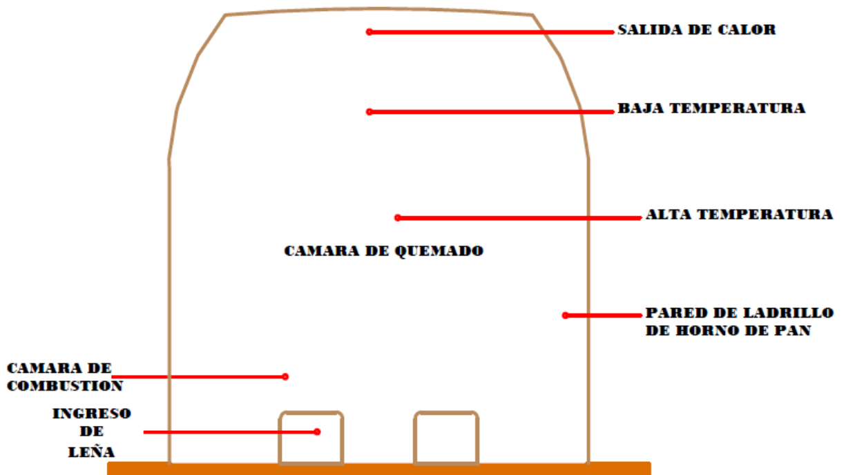
Figura 61. Puntos de calor del horno.
