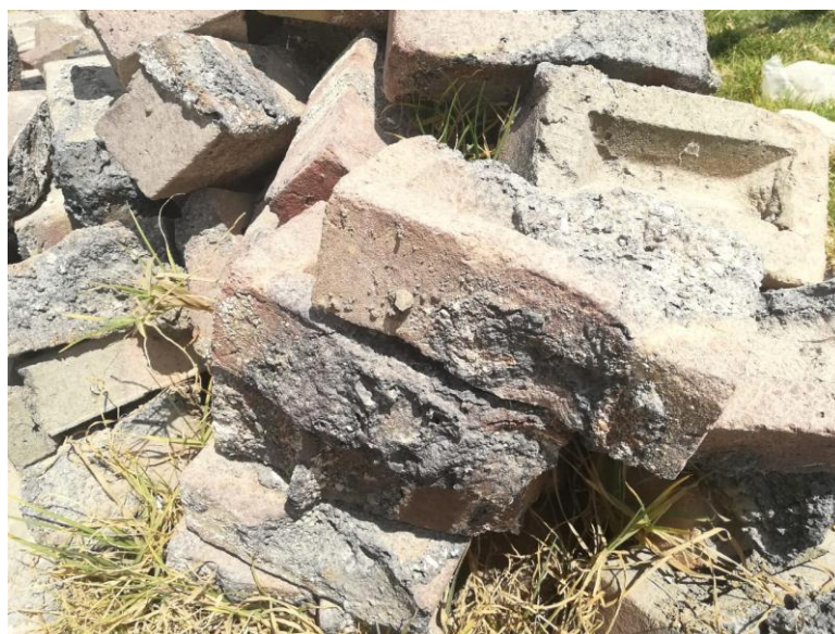
Figura 57. Vista de un ladrillo en exceso de temperatura.
