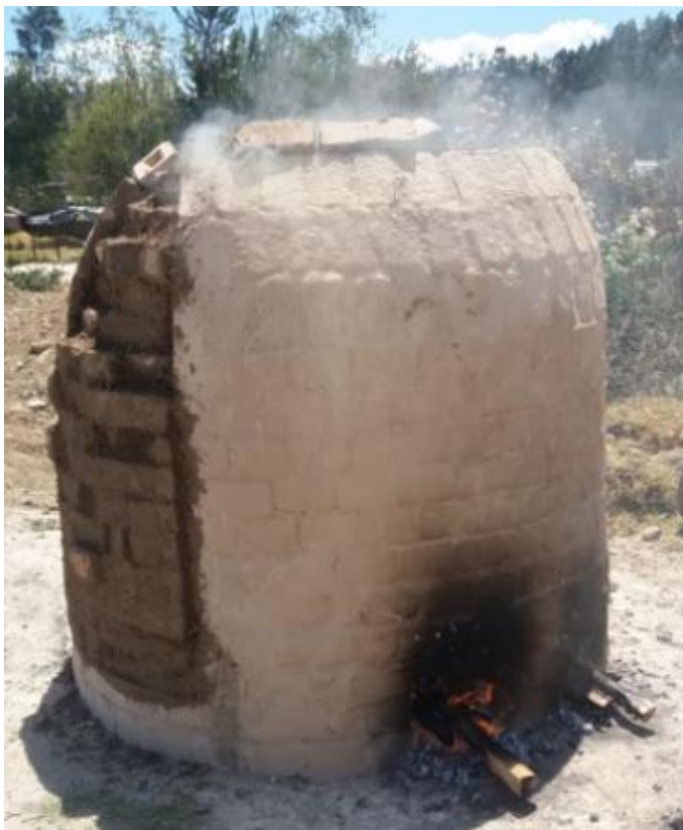
Figura 53. Vista exterior de los ductos de alimentación de combustible.
