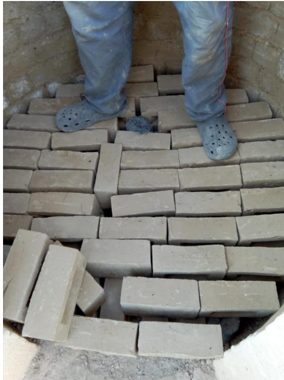
Figura 56. Vista de posición del ladrillo crudo en el horno.
