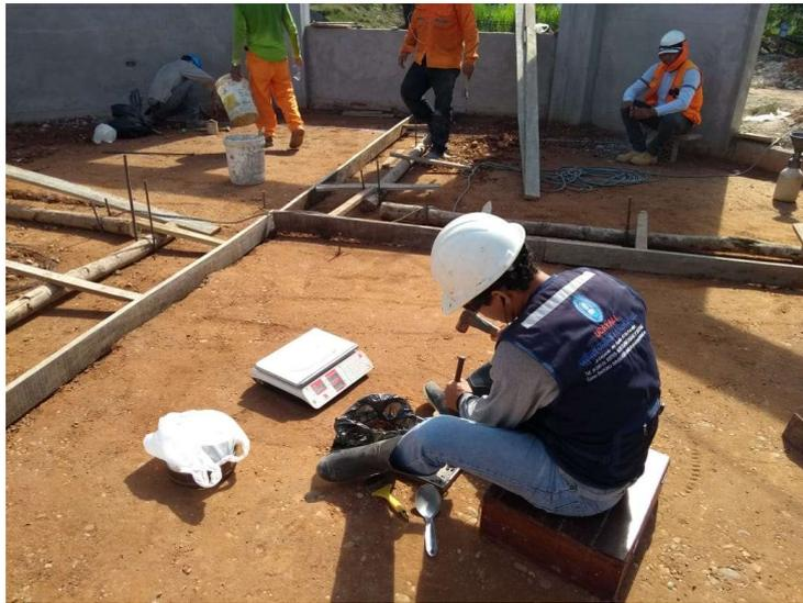
**Fotografía N° 5, Prueba de densidad de campo**
