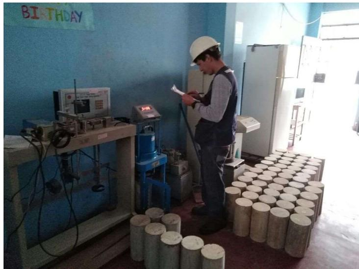
**Fotografía N° 4, prueba de compresión axial del concreto**
