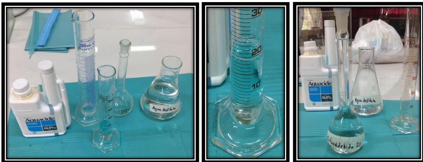
Glutaraldehído (AQUACIDE 10.5%). para obtener glutaraldehído al 2% se realizó mediante la fórmula de dilución, en una probeta se midió 19 mL de glutaraldehído (AQUACIDE) y se echó en un matraz aforado, seguidamente se enrasó 100 mL de agua destilada obteniendo glutaraldehído al 2%.
