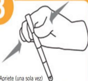
Apriete (una sola vez) la ampolla en la parte superior de KWIK-STIK™ (justo por debajo del menisco de líquido de la ampolla) situado en la tapa para liberar el líquido hidratante.
