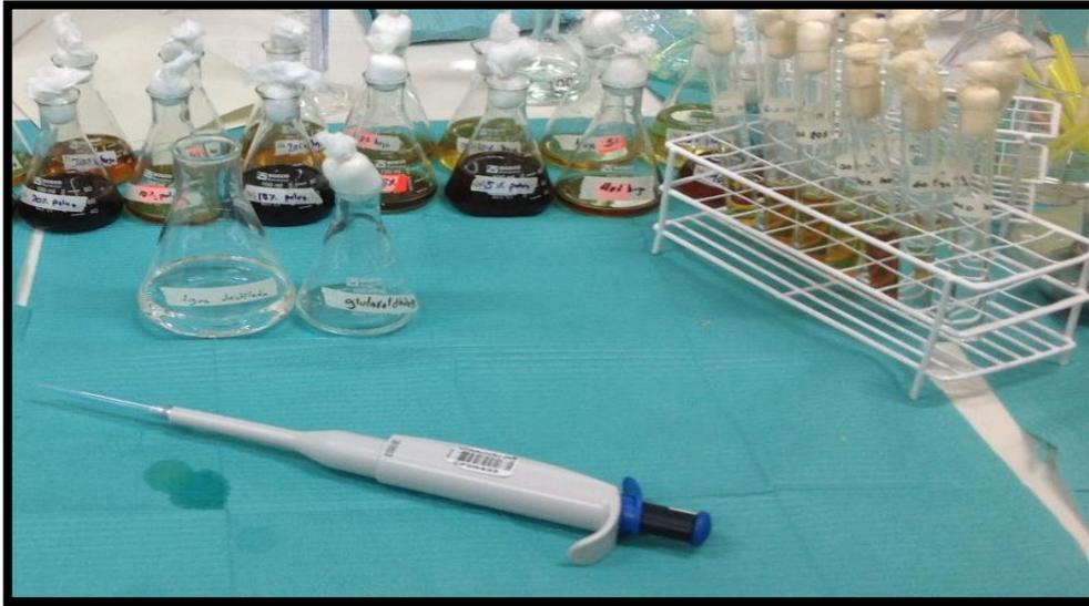
En tubos de ensayo estéril y rotulado se colocó 5 mL de cada concentración. En tubos de ensayo se preparó agua de peptona 5 mL.
