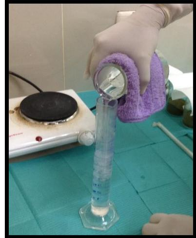
Para su extracción acuosa en un matraz con agua destilada se puso en una cocina eléctrica y se echó en una probeta 100 ml de agua destilada y a una temperatura de 60° c.
