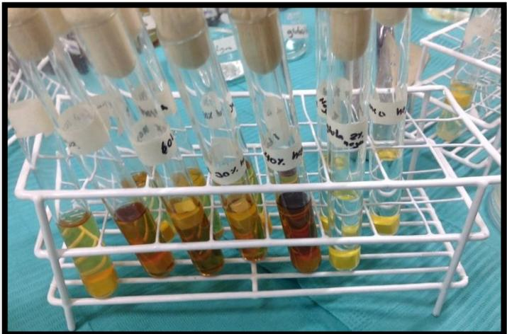
Se agito el tubo de ensayo con el desinfectante y el cubo de silicona contaminado y con la micropipeta se obtuvo 0.1 mL y se colocó en tubo con agua de peptona.
