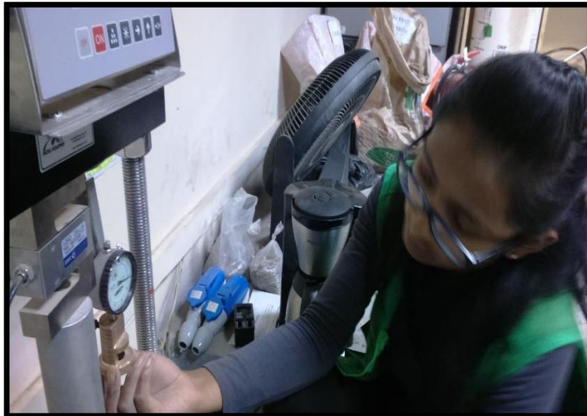
Anexo 1.33: Retirando la probeta de la prensa
