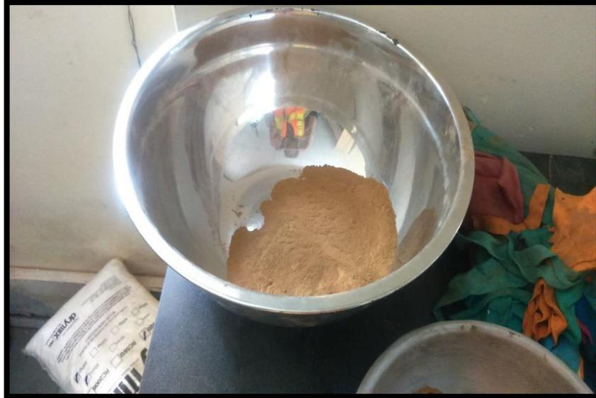
Anexo 1.12: Mezclando el material con agua. Primero con 5 ml y después con 3 ml según lo requiera.
